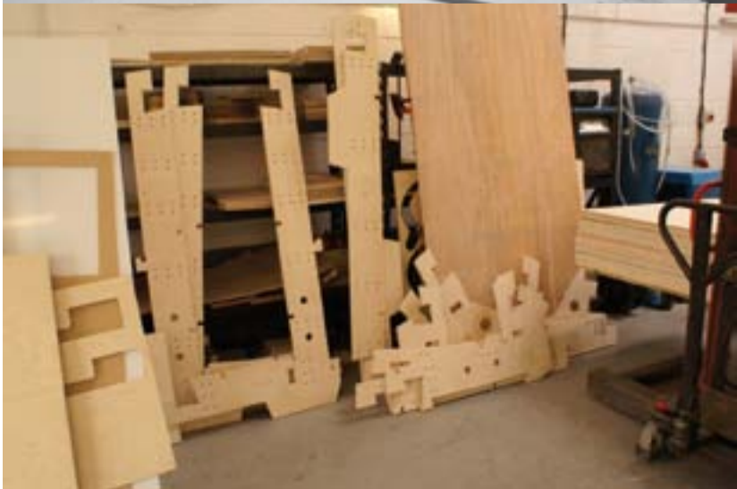
wikihouse -ში გამოყენებული მთავარი მასალაა 18 მილიმეტრიანი სტრუქტურული დამუშავებული ფანერა.
