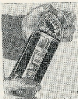
ნახ. 4. მულტიპლერები — ანალიზური ხელსაწყო, რომელიც შედგება 16 კანონიკაგან. მას აქვს ფოტოდეტექტორები, რომლებიც ფოტოფორს ადვანსებს სიცოცხლისთან დაკავშირებული რეაქციების. ძირითადი იმედი ემყარება რეაქციის ფოსფატაზის ტიპის (თუ იგი იქ არის) მარსისებულ ფერმენტებსა და ფოსფატთან ადვანსებულ ფოტოფორსებში რეაქტიური ნივთიერებათა შორის. თუ შესაფერისი ფერმენტი არსებობს, მან უნდა აშუადღოს ნაერთის, გამოავლინოს მისი ფოტოფორსენციის, რომელიც შემდეგ შეიძლება რეაქტიურიბულ იქნეს
