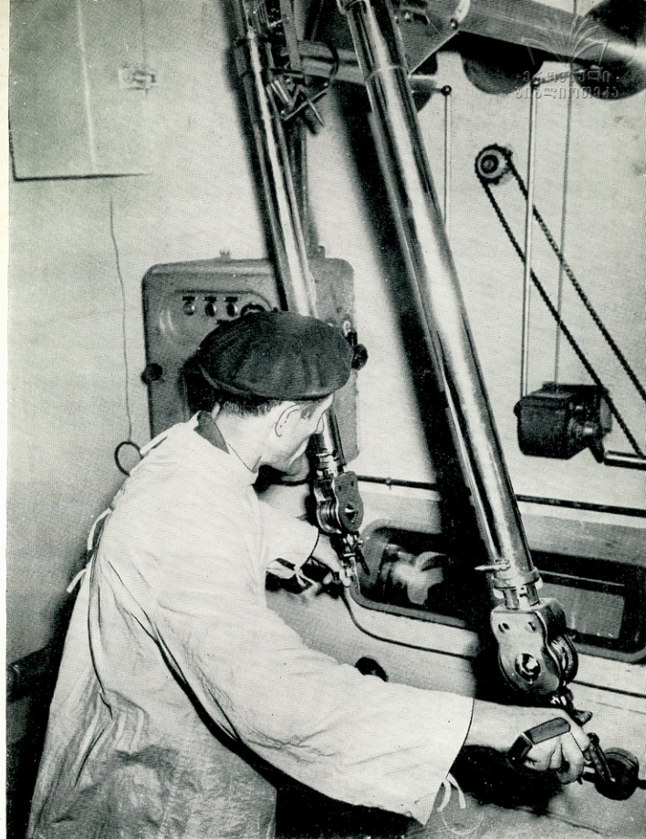
ბტომური რეაქტორის „ცხელ კამერაში“ გათვალისწინებული დისტანციურად მოქმედი მექანიკური ხელეხი — მანამუღაც.
