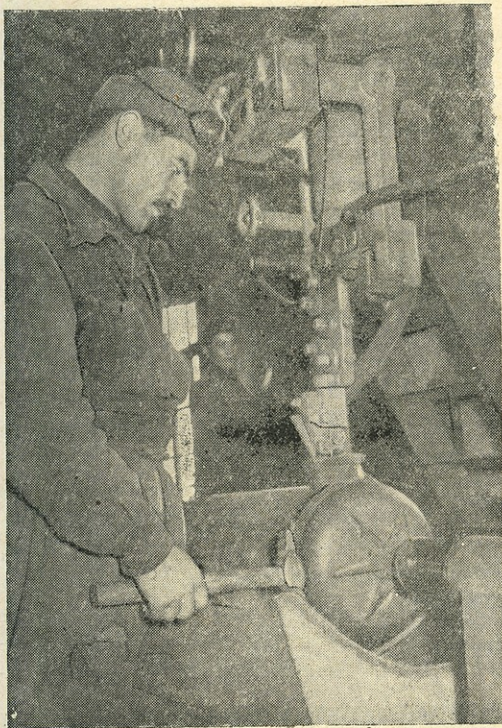
აირის ბალონის ნაწილების ელექტროავტომატური შედულება
