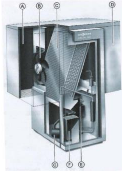
ნახ. 4.5 „ჰაერ-წყლის“ თბური ტუმბოს სქემატური ტექნოლოგიური ჭრილი.
