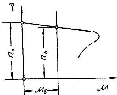
ნახ. 160. ასინქრონულ ელძრავის დატ- ვირთვასა და ბრუნვათა რიცხვს შორის დამოკიდებულება.
