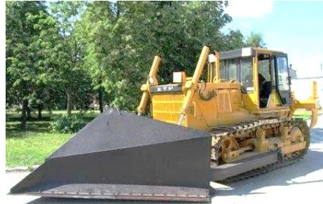
სურ. 3.10. მუხლუხათვლიანი ბუჩქსაჭრელი მანქანა ჰიდრავლიკური შეკიდებული სამუშაო ორგანოთი
