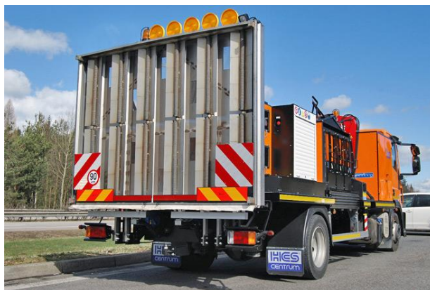
სურ. 3.65. თვითმავალი ავტონომიური სისტემა ასფალტბეტონის საფარის ინფრაწითელი სხივებით გასაცხელებლად
