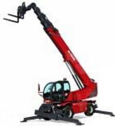
სურ. 6.27. ტელესკოპური დამტვირთველი მბრუნავი პლატფორმით Magni RTH 5.39 S
