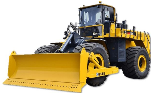
სურ. 2.36. პნევმოთვლიანი ბულდოზერი XCMG DL560 (ჩინეთი)
