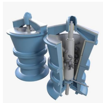
სურ. 5.16. გირაციული ქვასამსხვრევის 3D მოდელი
