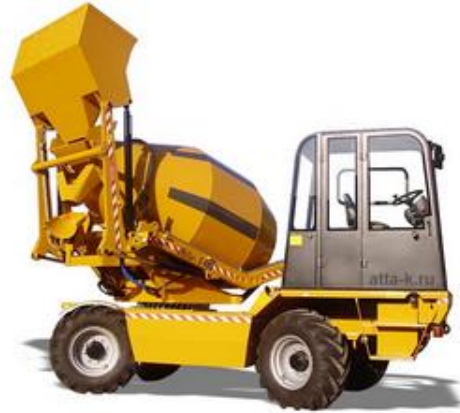
სურ. 3.40. იტალიური თვითდამტვირთავი ავტობეტონსარევი MACMIX MEVBT3500
