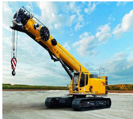
სურ. 4.29. ჰიდრაულიკური ტელესკოპური ამწე (ჩინეთის სახალხო რესპუბლიკა)
