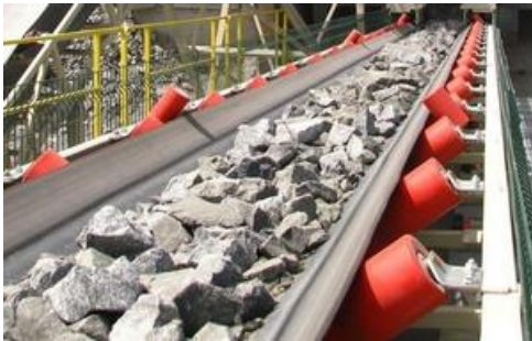
სურ. 7.30. ლითონის ლენტისანი კონვეიერი ნატეხი მადნეულის სატრანსპორტოდ
