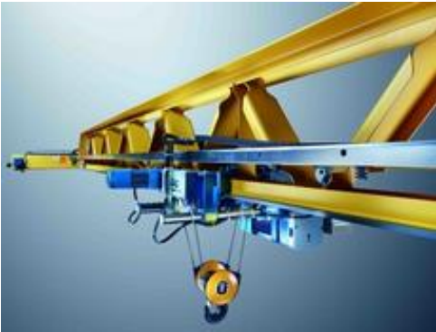
სურ. 4.22. კონსოლებიანი ჯოჯგინა ამწის სატვირთო ურიკის განთავსება წამწის (ხიდის) ქვედა სარტყლის თაროზე
