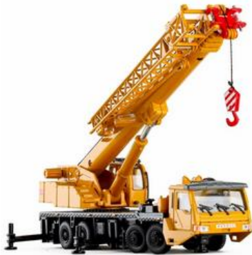
სურ. 4.42. ოთხღერძიანი პნევმო-თვლიანი ამწე ტელესკოპური ისრითა და აუტრიგერებით
