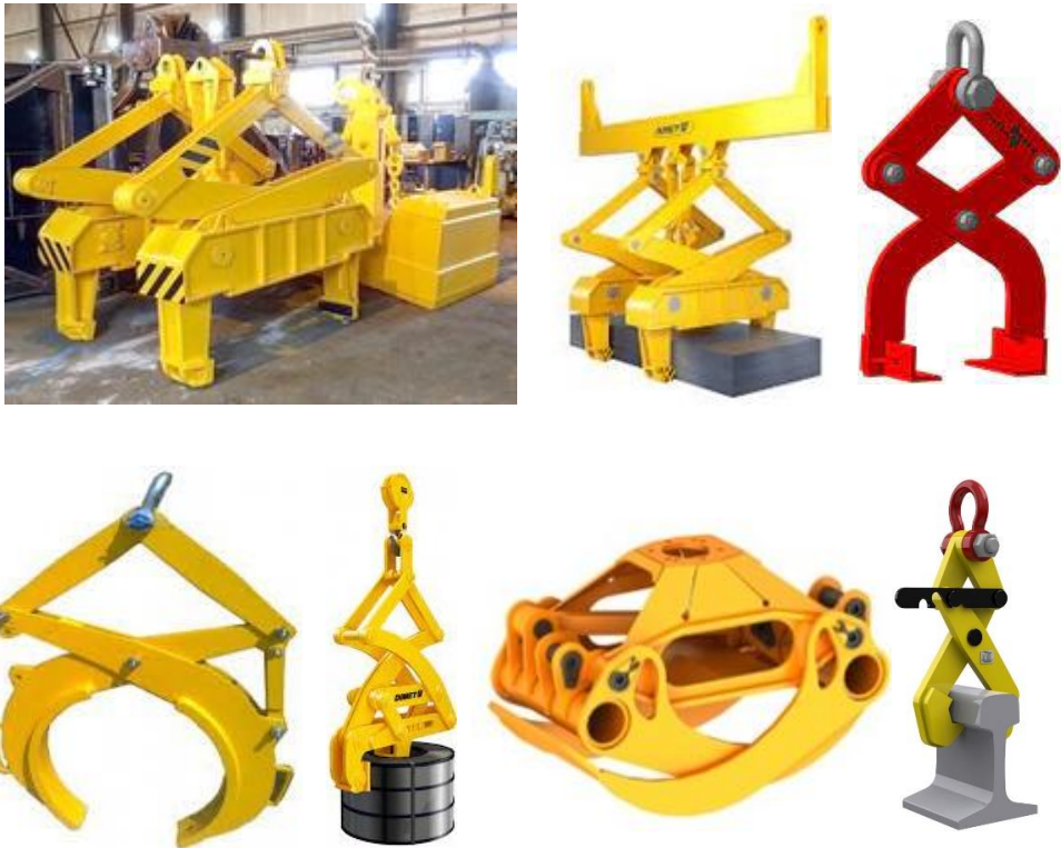
სურ. 8.28. მარწუხისებრი (მოსაჭერი) ტვირთსატაცი მოწყობილობები
