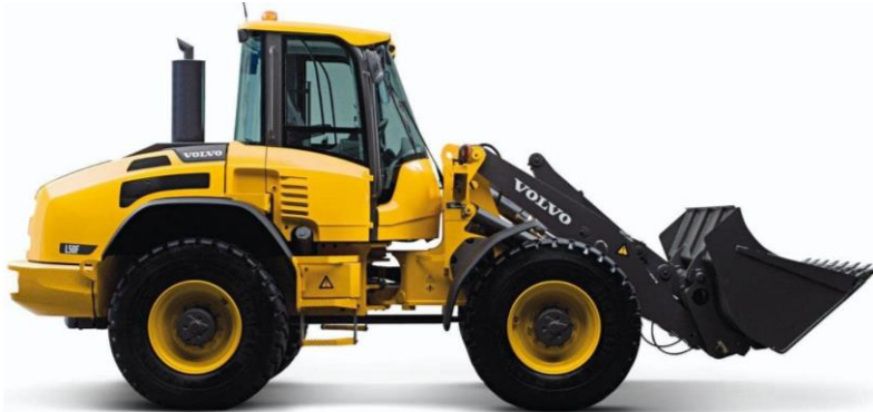
სურ. 6.7. ციცხვიანი ფრონტალური ავტოსატვირთველი VOLVO L60F
