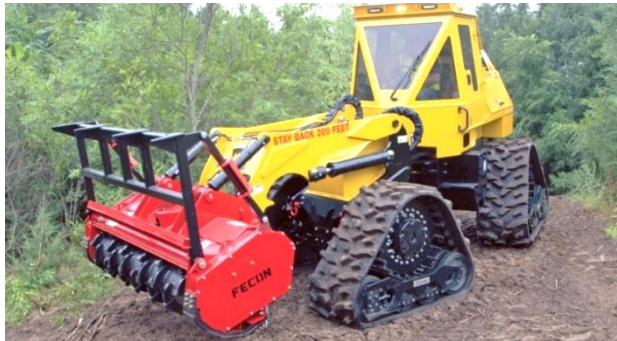
სურ. 3.11. მოდერნიზებული თანამედროვე ბუჩქსაჭრელი (მუშტა საჭრისით) მანქანა. (მწარმოებელი კომპანია LineBacker აშშ)
