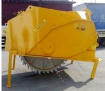
სურ. 2.31. ტრაქტორზე შესაკიდებელი ტრანშეასათხრელი RA700 Valentini
