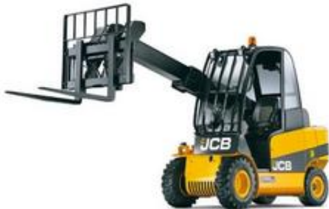
სურ. 6.17. ტელესკოპური ჩანგლებიანი ავტოსატვირთველი
