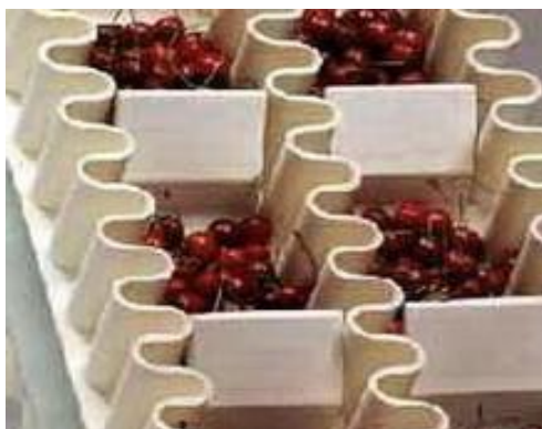
სურ. 7.23. კონვეიერის პოლიმერული ლენტი გოფირებული კედლებით
