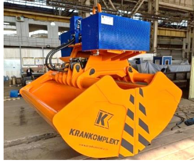
სურ. 3.18. ღია ტიპის ელექტრო-ჰიდრავლიკურ ამძრავიანი გრეიფერი
