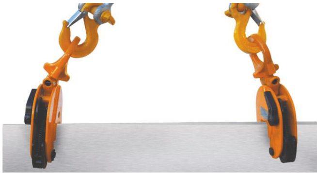
სურ. 8.32. ლითონის ფურცლის ტრანსპორტირება ვერტიკალურად
