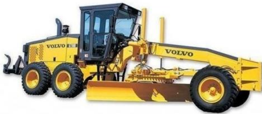
სურ. 2.80. VOLVO-ს ფირმის თვითმავალი ავტოგრეიდერები: მარცხნივ G746B, მარჯვნივ 9165
