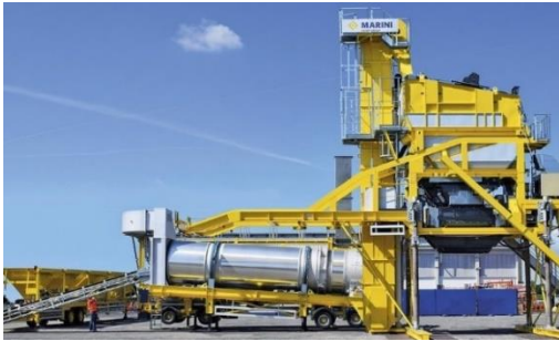
სურ. 3.49. მობილური ასფალტბეტონის შემრევი
