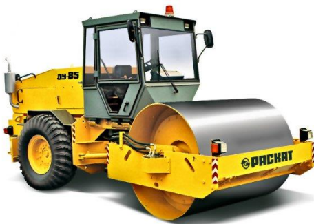
სურ. 2.102. თვითმავალი ვიბროსატკეპნი DY-85
