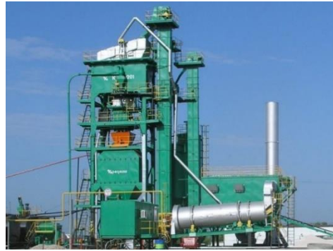
სურ. 3.45. უკრაინული წარმოების კომპურა ასფალტშემრევი დანადგარი KDM201
