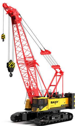
სურ. 4.28. მუხლუხა ამწე SCC800A სამონტაჟო მუხლუხა ამწე
