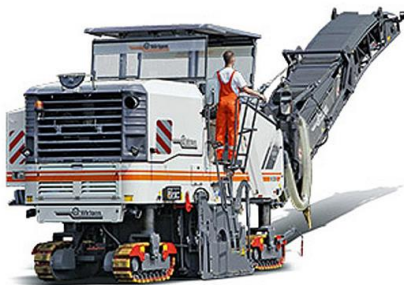
სურ. 3.57. გერმანული წარმოების უნივერსალური სადარავი მანქანა WIRTGEN W 200 B
