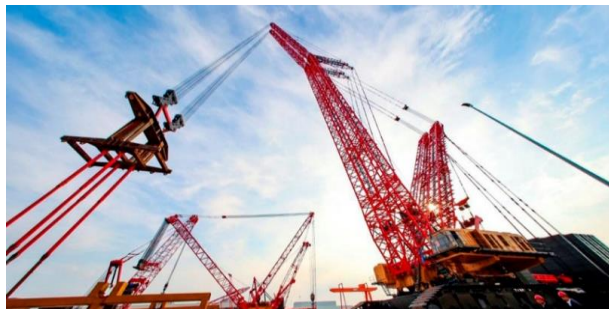
სურ. 4.30. მსოფლიოში უდიდესი მუხლუხა ამწე SCC9800TM ტვირთამწეობით 4500 ტ (ჩინეთი)
