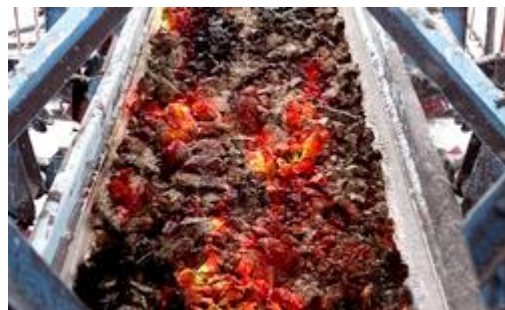
სურ. 7.31. ლითონის ლენტისანი კონვეიერი მეტალურგიული წილის სატრანსპორტოდ
