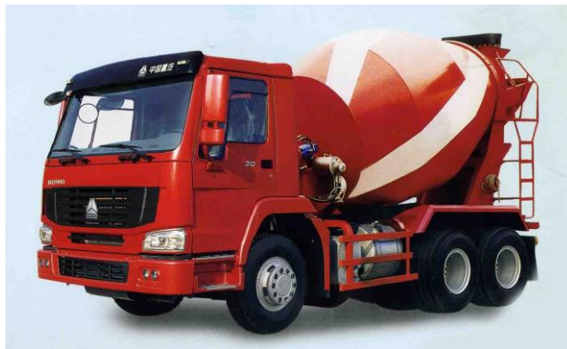
სურ. 3.36. ავტობეტონსარევი HOWO ZZ5327GJBN3647C (ჩინეთი)
