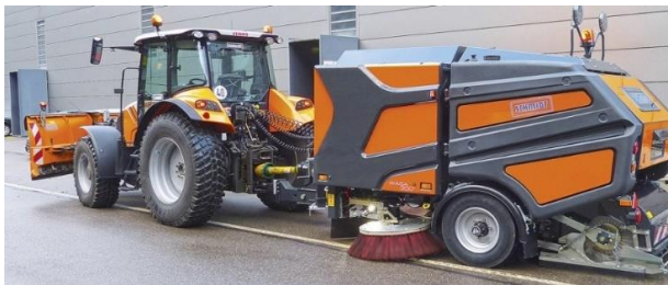
სურ. 3.72. „მმიდტის“ ფირმის (გერმანია) ტრაქტორზე მისაბმელი საგველ-დამლაგებელი მანქანა
