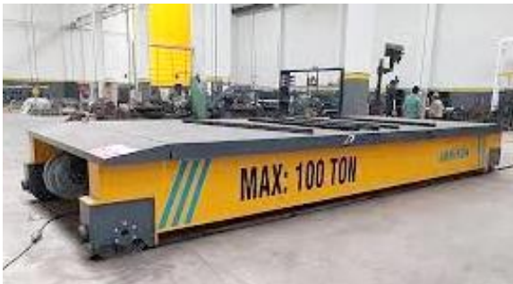
სურ. 4.10. ტექნოლოგიური ამწე. ტვირთების უსაფრთხოდ გადასატანი სატრანსფერო ურიკა
