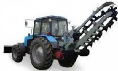
სურ. 2. 62. პნევმოთვლიანი ჯაჭვური მრავალციცხვიანი ექსკავატორი
