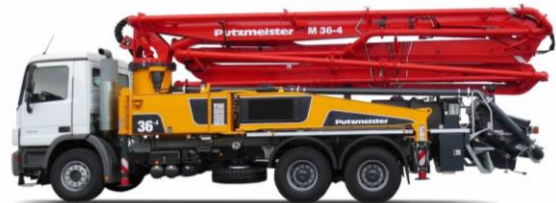
სურ. 3.39. ავტობეტონსატუმბი Putzmeister M 36-4 (გფრ)
