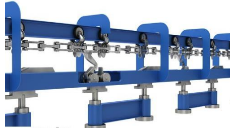
სურ. 7.43. დაკიდებული წამბიძგებელი კონვეიერი
