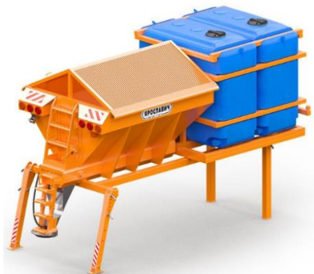
სურ. 7.75. რეაგენტების კომბინირებული გამანაწილებელი
