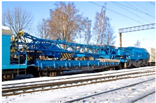
სურ. 4.54. სარკინიგზო ამწე ტრანსპორტირების მდგომარეობაში
