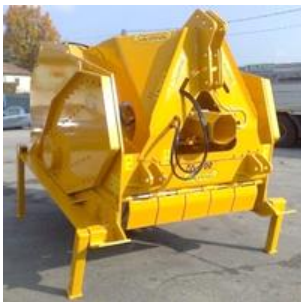
სურ. 2.31. ტრაქტორზე შესაკიდებელი ტრანშეასათხრელი RA700 Valentini
