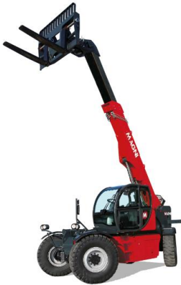
სურ. 6.26. ტელესკოპური მობრუნებადი დამტვირთველი Magni HTH 20.10 (იტალია)
