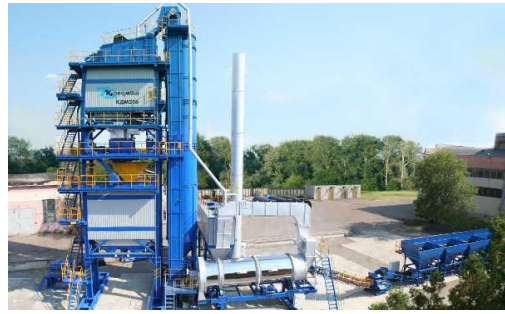
სურ. 3.50. სტაციონალური ასფალტბეტონის შემრევი
