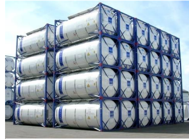
სურ.7.66. დათაკარებული (დამტაბელებული) კონტეინერი-ცისტერნები
