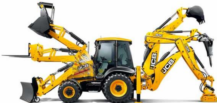
სურ. 2.66. უნივერსალური ექსკავატორი პნევმატურთვლიანი ტრაქტორის ბაზაზე
