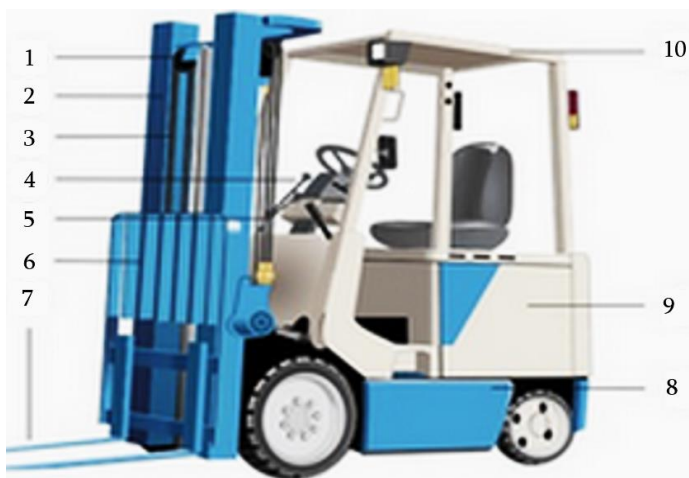
სურ. 6.10. ჩანგლებიანი ავტოსატვირთველის კონსტრუქციული სქემა: 1-საკისარი; 2-ისარი; 3-ჯაჭვი; 4-სამართავი ბერკეტი; 5-ჰიდროცილინდრი; 6-პლატფორმა; 7-ჩანგალი; 8-შასი; 9-ძრავი; 10-კაბინა
