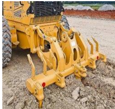
სურ. 2.81. ავტოგრეიდერის დამატებითი მოწყობილობა „გამაფხვიერებელი“ (წერაქვი)
