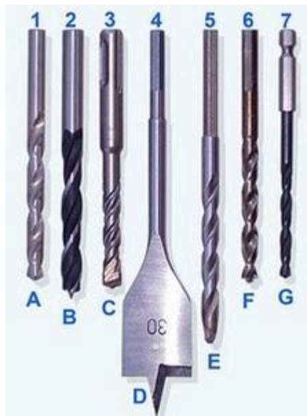
სურ. 6.1. ბურღის სახეობები: A-ლითონის; B-ხის; C-ბეტონის; D-ხის პირველი (უძველესი) ბურღი; E-უნივერსალური ლითონის და ბეტონის; F-ფურცლოვანი ლითონის; G-უნივერსალური ლითონის, ხის და პლასტმასის. ბოლოები: 1, 2-ცილინდრული; 3-SDS-plus; 4-ექვსწახნაგა; 5-ოთხწახნაგა; 6-სამწახნაგა; 7-სჭვალსახრახნისთვის
