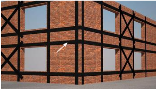
სურ. 11.18. აგურის მზიდი გარე კედლის გაძლიერება ნახშირბადბოჭკოვანი კომპოზიტიური ლენტით
