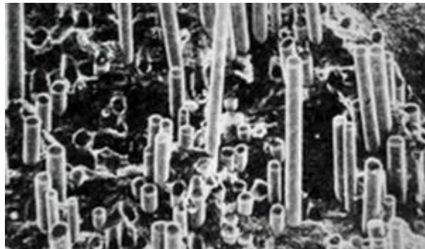
სურ. 13.9. მინაკერამიკის კომპოზიტის განშრეებისა და ბოჭკოების მატრიციდან ამოძრობის მიკროსკოპიული სურათი
