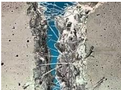
სურ. 9.30. ბოჭკოებით დაარმირებული ფიბრობეტონი
