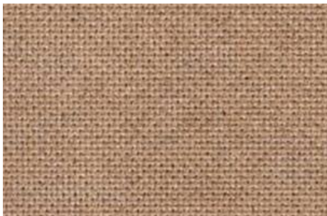
სურ. 8.18. მაზონიტი – ბადისებრი ფაქტურის საშუალო სიმკვრივის ფილა
