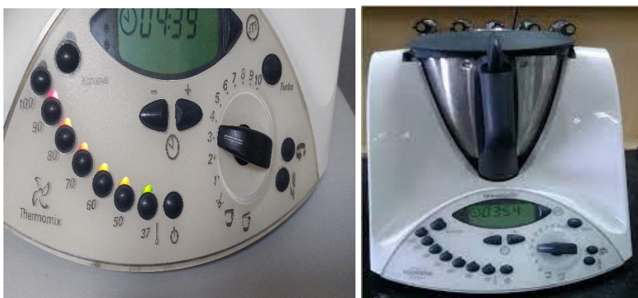
სურ.1. ხელსაწყო ლაბორატორიულ პირობებში რძის პასტერიზაციისა და ჰომოგენიზაციისთვის (thermomix, საფრანგეთი)
