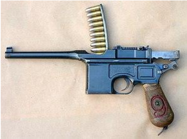
სურ. 44. Mauser K-96 მოდელი 712 "Schnellfeuer" mod. 1932 - ავტომატური ვერსია მოსახსნელი მჭიდით. ავტომატურ სროლის რეჟიმში სროლის სიჩქარე დაახლოებით 850 გასროლა წუთში
