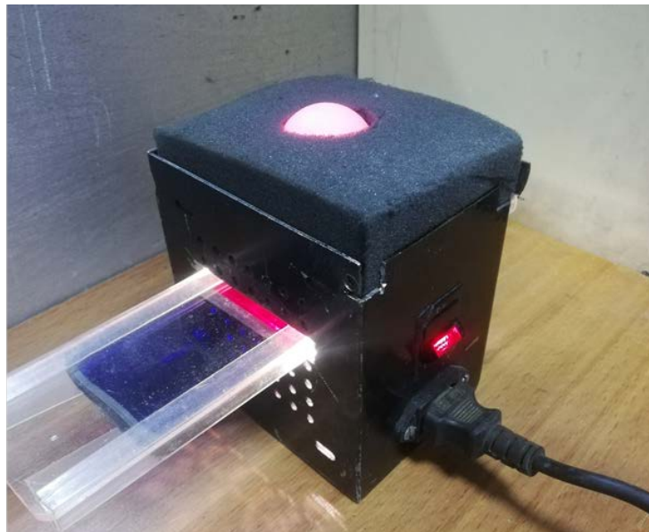
სურ. 34 ხილული სპექტრის მოდერნიზებული ფოტოპლემზომოგრაფის მოქმედი მაკეტი
