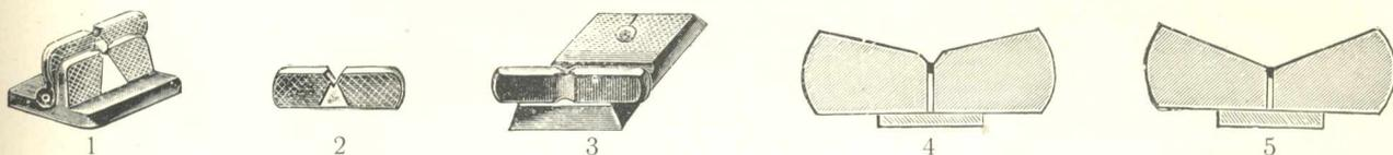
Къ двухствольнымъ и одноствольнымъ штуцерамъ, а также къ бюксфлинтамъ я примѣняю, если не послѣдовало особаго заказа, такъ называемую прицѣльную колодку съ подъемнымъ щитикомъ (см. рис. № 1). Весь прицѣльный механизмъ матовой синей закалки и имѣетъ подъ прорѣзами серебряный треугольникъ, облегчающій въ сумеркахъ нахождение прорѣзи и мушки.
