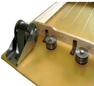
სურ. 84 დაზგა ჩარჩოში მავთულის გასაჭიმად: 2- მბრუნავი კოჭი, 3-5 მავთულის კოჭას ნაწილები, 6-ფიქსატორები
