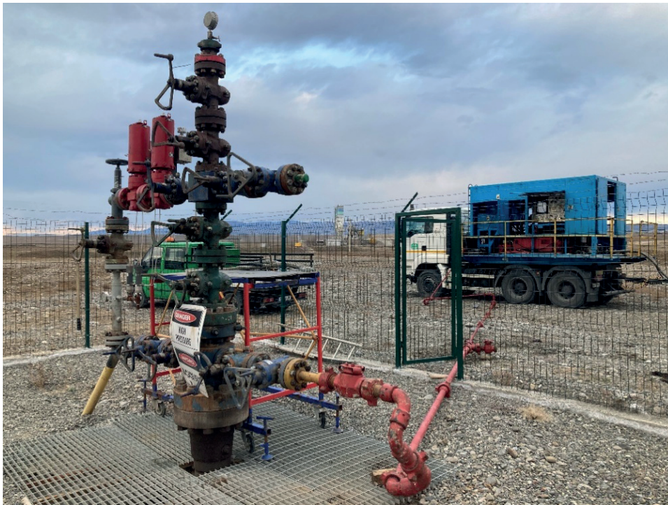
სურ. 3. ჭაბურღილში აზოტის გატუმბვა საექსპლუატაციო პაკერის არარსებობის პირობებში
