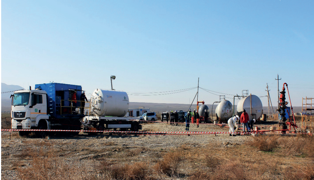
სურ. 1. ჭაბურღილში აზოტის გატუმბვა თხევადი აზოტის გარდამქმნელი ტუმბოს გამოყენებით
