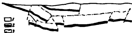
ნახ. 30. საბადო მირგალიმსაის უბნის სქემატური კროლი (მალაროს დოკუმენტაციის მასალების მიხედვით) 1—კირქვა; 2—მადნისშემცველი კირქვების („მეორე ბათისებრი“) პორიზონტი; 3—ღიზუნქტიური აშლილობები
