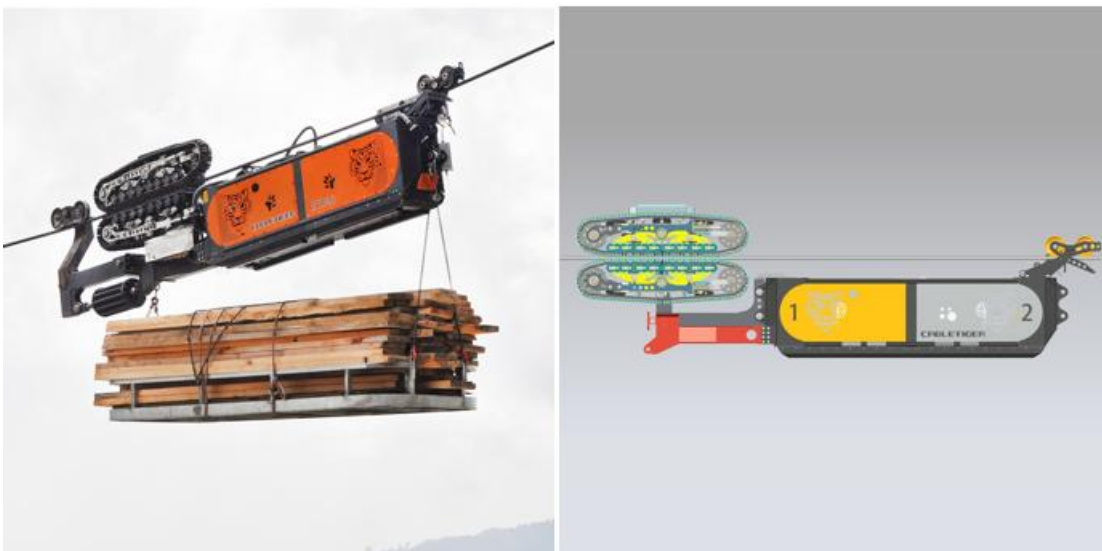
სურათი. 10 თვითმავალი საბაგირო გზის ტვირთების გადასატანი მოწყობილობა.
