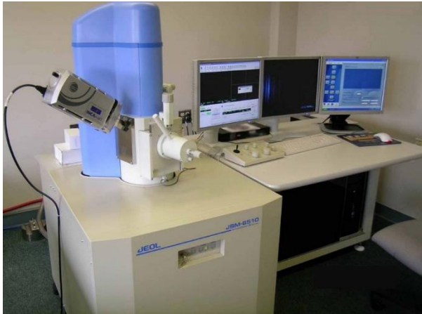
სურათი 10. მასკანირებელი ელექტრონული მიკროსკოპი JEOL JSM-6510 (ა) და ვაკუუმ კამერა JEOL JEC3000FC/AUTO FINE COATER (ბ)
