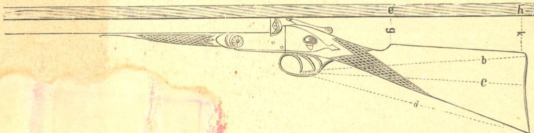
Длина ложи считается отъ перваго спуска до середины затылка приклада по прямымъ линиямъ  $b-c-d$ . Для опредѣленія изгиба ложи, надо приложить къ верхней прицѣльной планкѣ линейку, какъ показано на рисункѣ, и измѣрить разстояние отъ линейки до носа и затылка приклада по линиямъ  $a$  и  $k$ .
