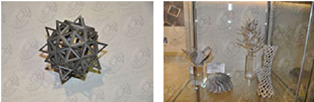
სურათი 3. SLM ტექნოლოგიით დამზადებული თერმოპლასტური პოლიურეთანის ნიმუშების მაგალითები
