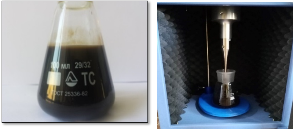
სურათი 32. გრაფენის ოქსიდის სუსპენზია (a) და მისი დამუშავება ულტრაბგერით ჰომოგენიზატორში (b)
