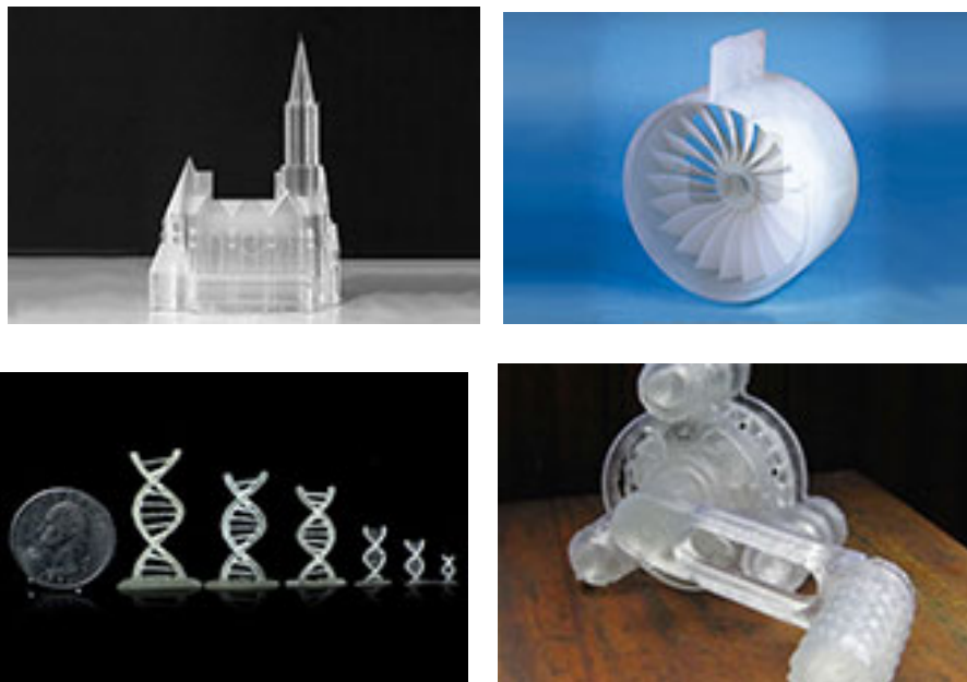
სურათი 2. SLA ტექნოლოგიით დამზადებული თხევადი ეპოქსიდის ნიმუშები
