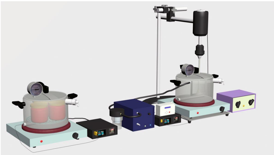
სურათი 8. ტომატ-პასტის დასამზადებელი ექსპერიმენტული მოდელური მოწყობილობის კონცეპტუალური სქემა
