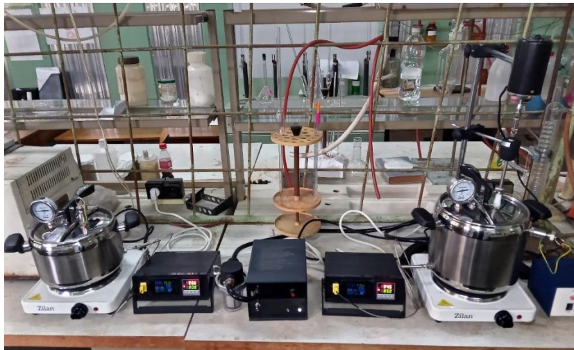
სურათი 13. ქიმიური და ბიოლოგიური ინჟინერიის დეპარტამენტის ლაბორატორიაში განთავსებული ტომატ-პასტის მოსამზადებელი მოდელური დანადგარი
