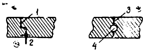
ნახ. 3.16 — კაშხალის ტანთან წყალსაცემი ფილის შეუღლების სქემები: 1 — გულრონის საფენი სისქით 2 სმ; 2 — გულრონის თვით დიამეტრით 5—7 სმ; 3—გულრონის სოგამანი; 4—ფიცარი.
