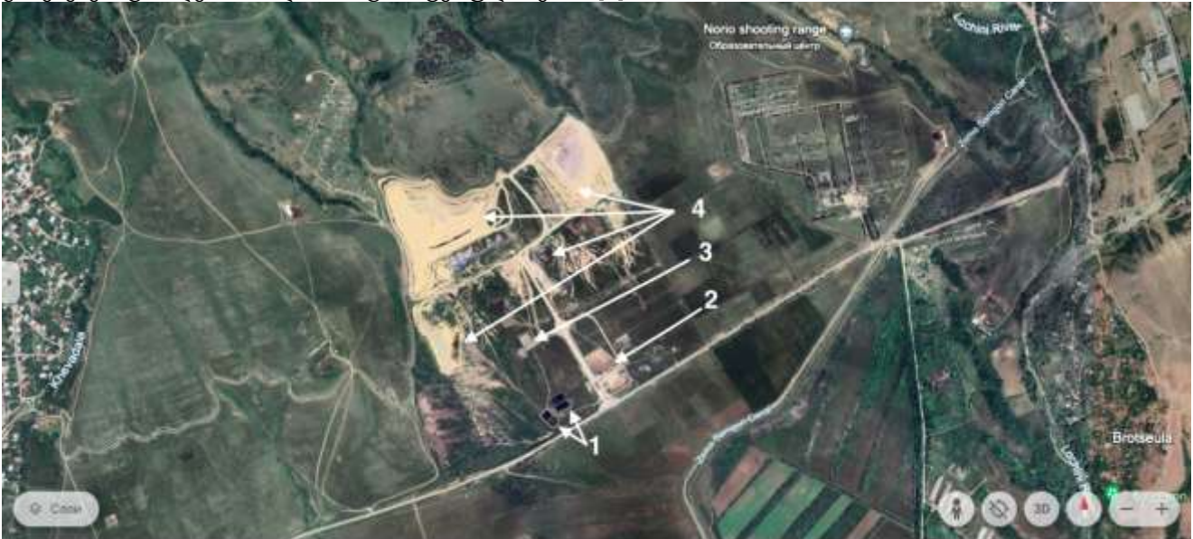
ნახ. 1. ნორიოს ნაგავსაყრელი (Google Earth, 2024) - 1. ნაჟური წყლების 4 ავზი/ღია რეზერვუარი, 2. ადმინისტრაციული შენობა; 3. ნაჟური წყლის გასუფთავების სისტემა - უკუოსმოსი (არ ფუნქციონირებს) 4. უჯრედები.
