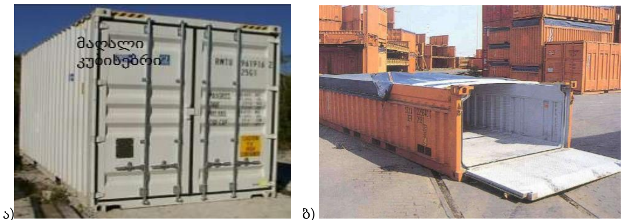
სურ. 2.2.2. უნივერსალური კონტეინერი 20 ფ /40 ფ (ა) და თავდია კონტეინერი 20 ფ /40 ფ (ბ)
