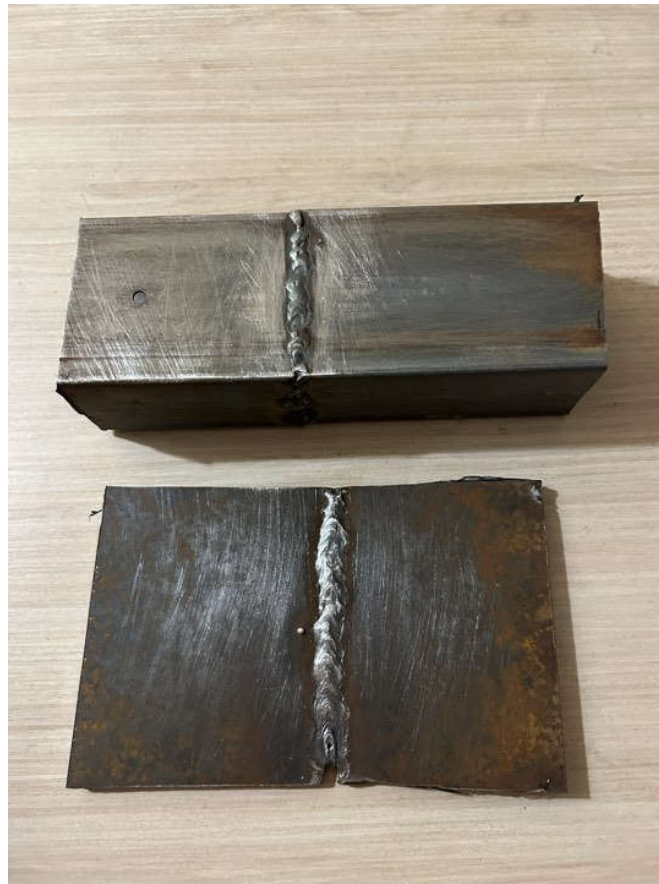
ნახ.4. 40x60 1 მმ სისქის ოთხკუთხა მილის და 2 მმ სისქის ფოლადის ფურცლის შენადული შეერთები
