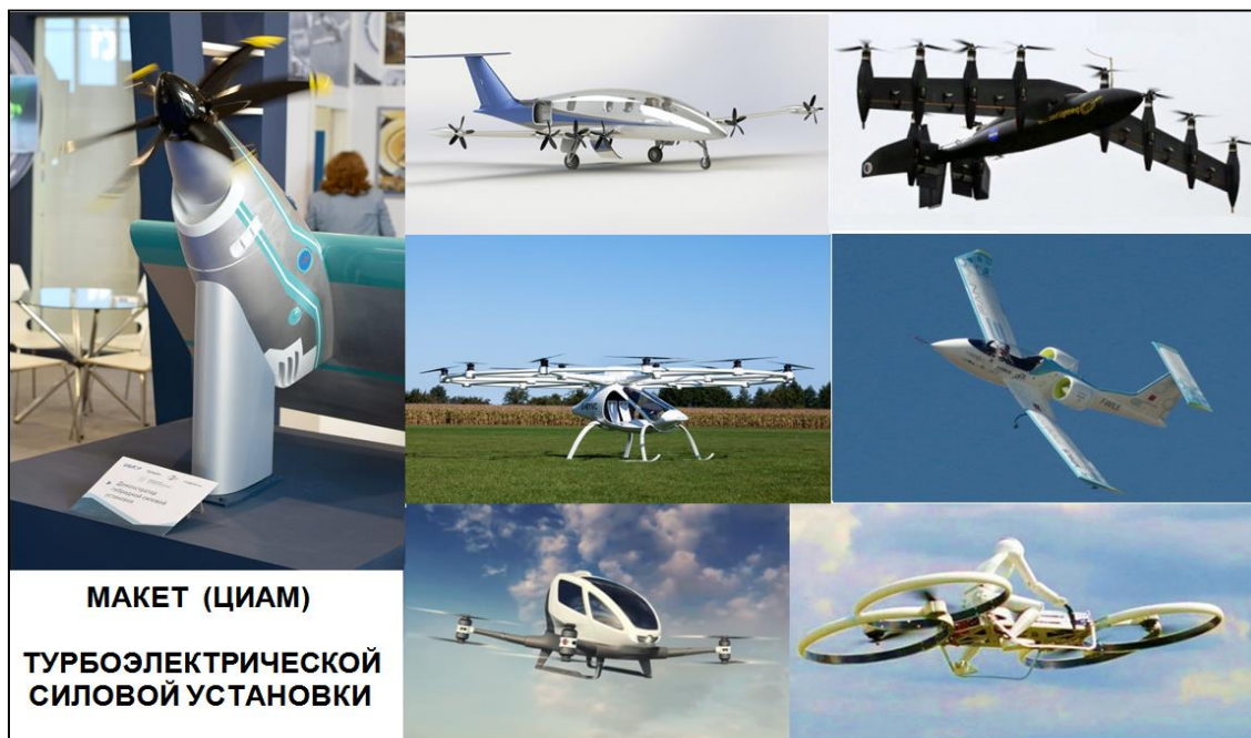
Рис.24. Компоновки с распределенными электрическими СУ [26]
