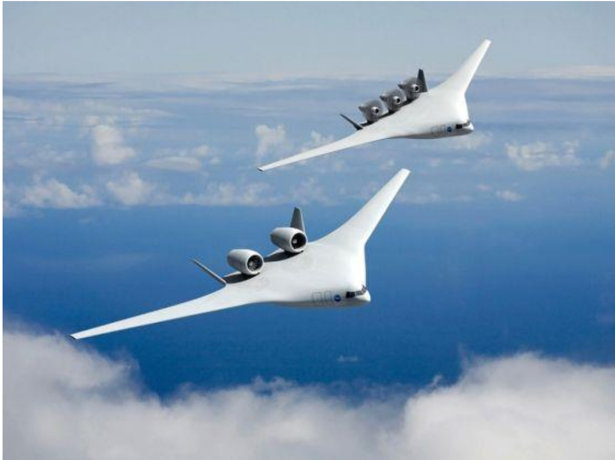
Рис.5. Компоновки по схеме «летающее крыло» фирмы «AIRBUS» [5]
