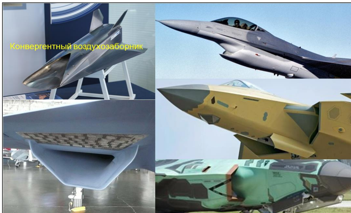
Рис.21. Многорежимные нерегулируемые сверхзвуковые воздухозаборные устройства пространственного (3D и конвергентного) типа [20,21,22]
