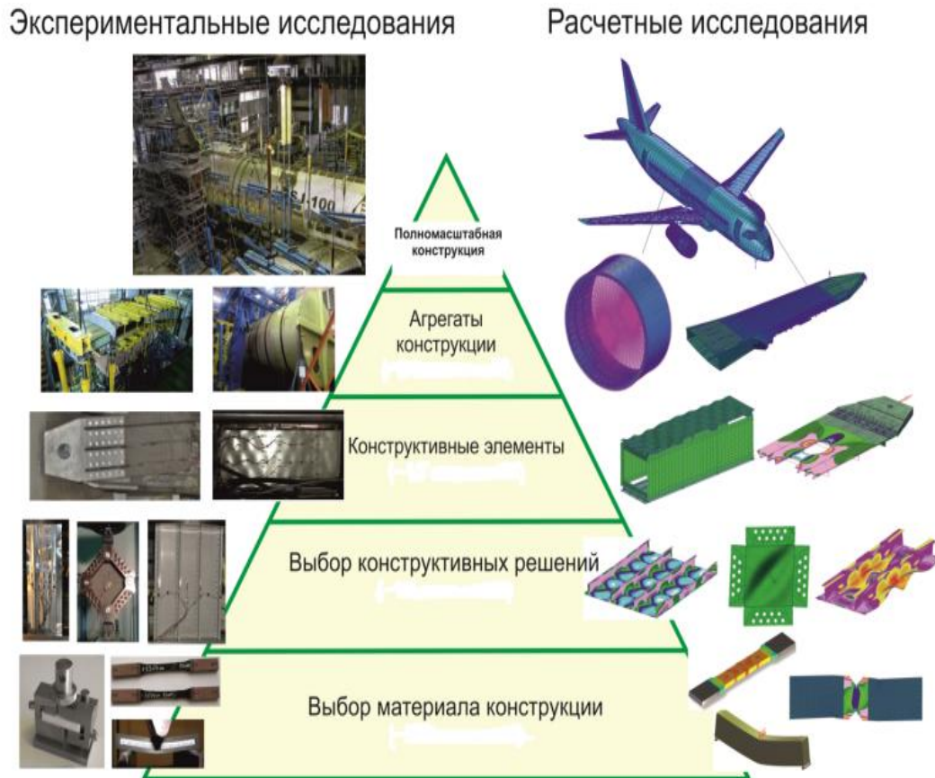
Рис.16. Многоуровневый расчетно-экспериментальный подход к отработке прочности конструкции самолета [16]
