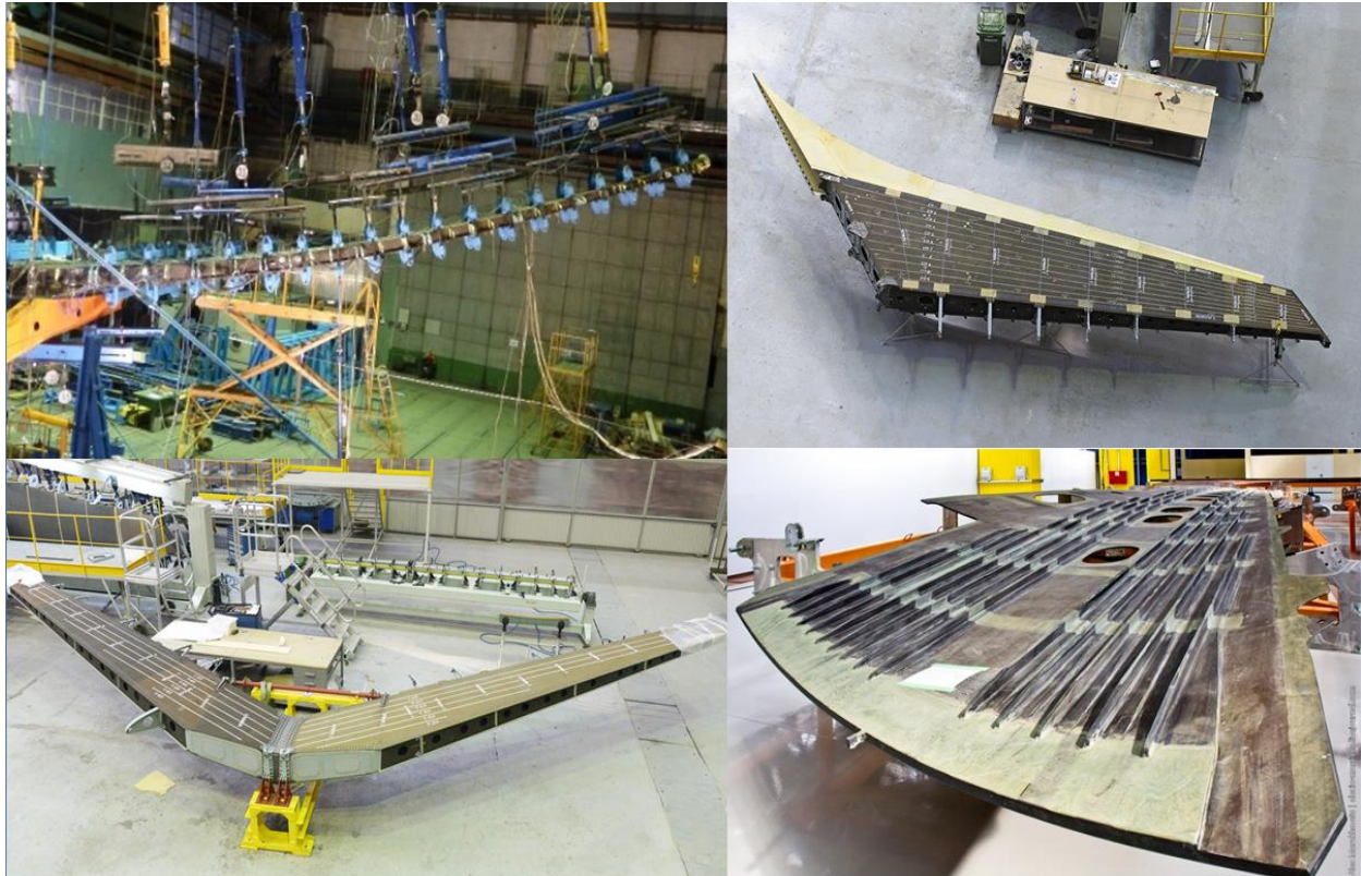
Рис.17. Внедрение ПКМ в конструкцию ответственных силовых агрегатов планера ЛА путем использования современных инфузионных технологий пропитки матрицы связующим и последующая отработка статической прочности [17]
