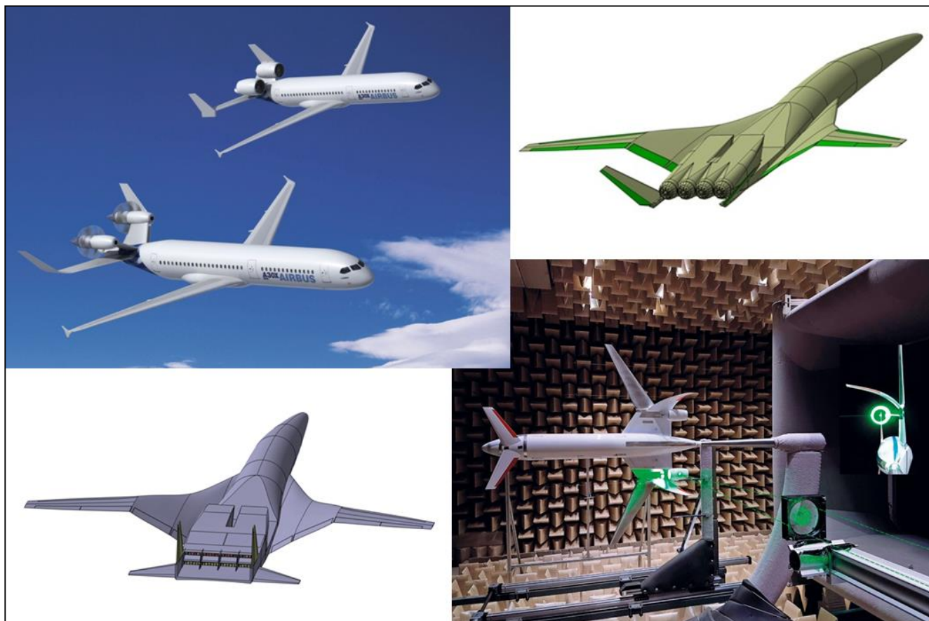
Рис.9. Компоновки с экранированием шума от силовой установки и несущих поверхностей самого ЛА [8]
