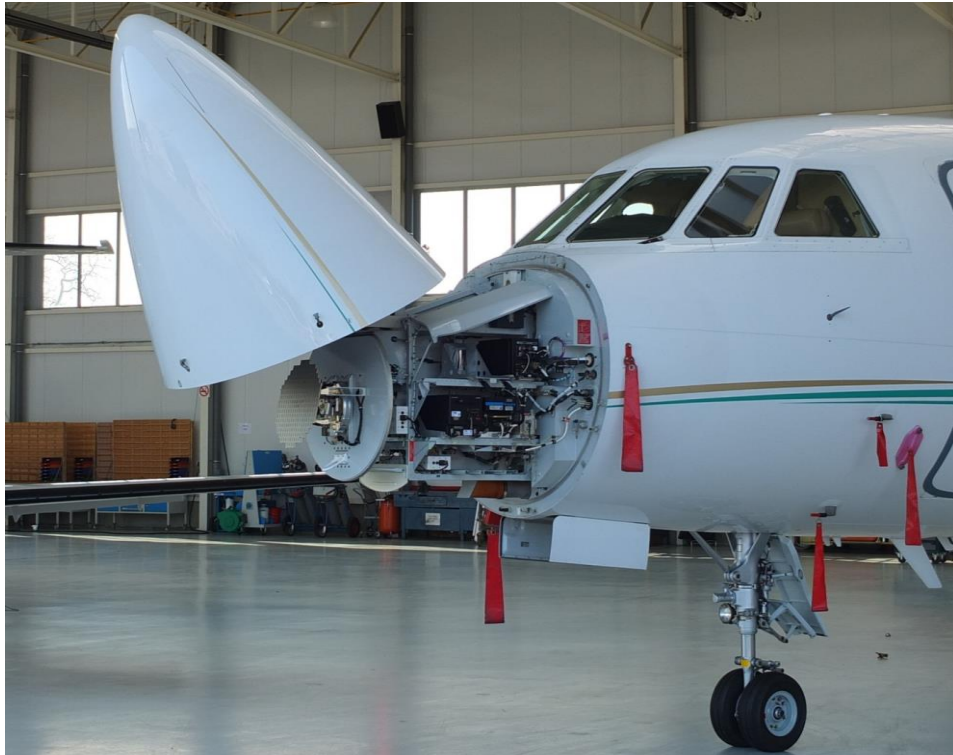
Рис.28. РЛС с пассивной и активной фазированной антенной решеткой [32]
