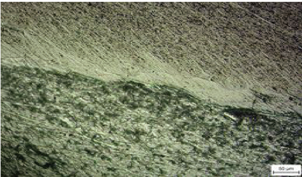
სურათი 4. შეერთების ტალღური ბუნება ცენტრალურ ნაწილში
