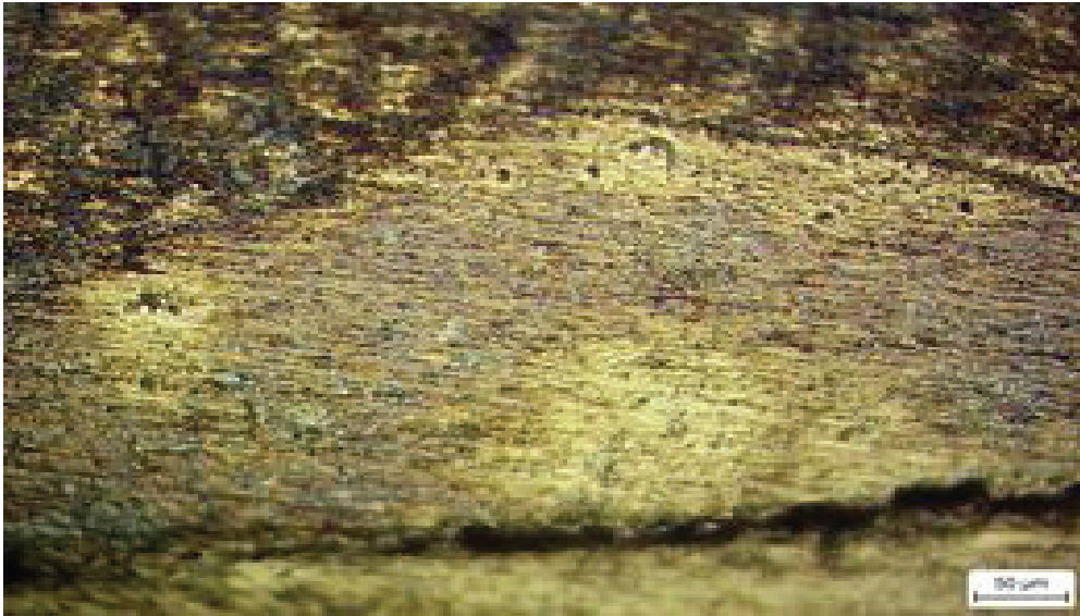
სურათი 3. დეფორმირებული მარმირებელი ფოლადის მავთული ბიმეტალში
