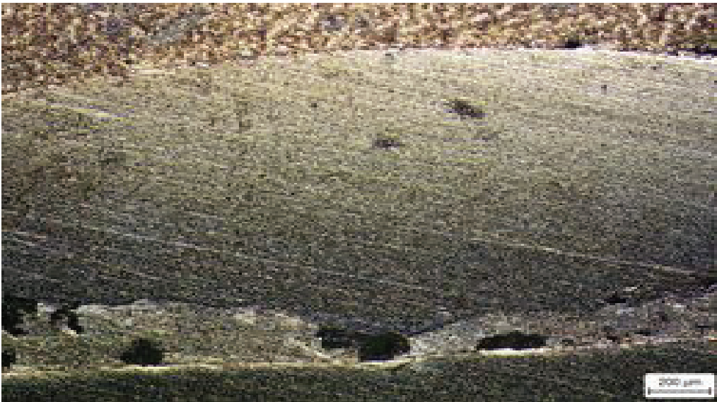
სურათი 6. გადნობის შედეგად მიღებული ერთიანი ინტერმეტალიდის ფენა
