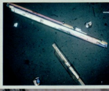
გამრეცხველიდან SALT EFFLORESCENCE
