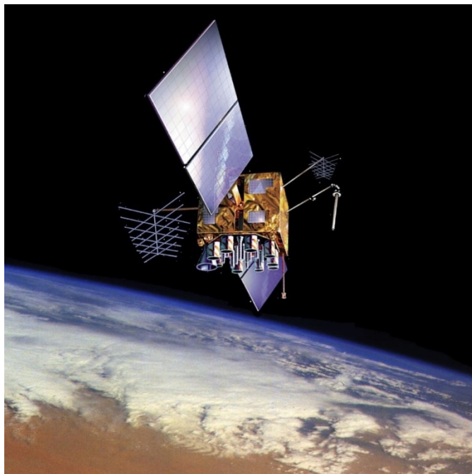
ნახ. 2.4 IIR-M, L2 სამხედრო სიხშირის GPS თანამგზავრი
