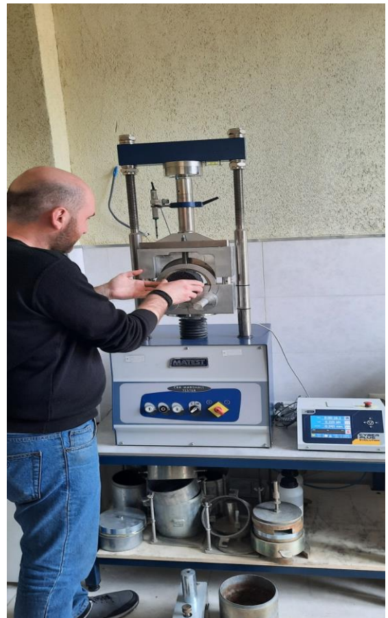
ნახ.59. ლოიტნერის ტესტის მიმდინარეობა
