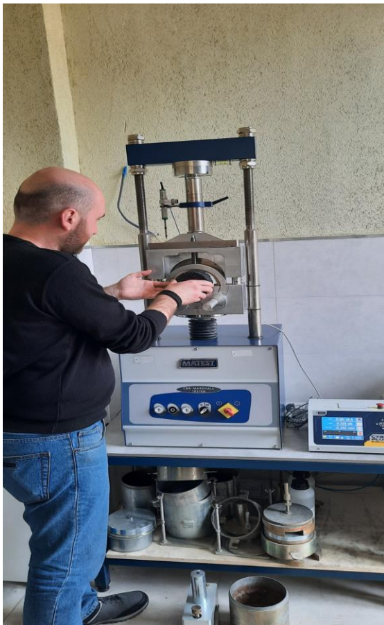
ნახ.59. ლოიტნერის ტესტის მიმდინარეობა
