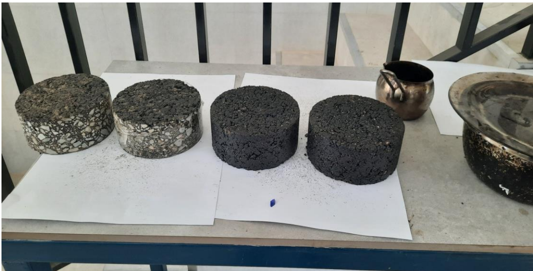
ნახ.44. დამზადებული ნიმუშები ჰამბურგის ბორბალზე გამოცდამდე
