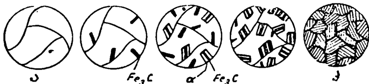
ნახ. 153. აუსტენიტში პერლიტის წარმოქმნის სქემა.
