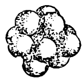
ნახ. 3. კრისტალური გისოსები: ა—სივრცით დაცენტრებული კუბი; ბ—წახნაგდაცენტრებული კუბი; გ—ჰექსაგონალური პრიზმა.
