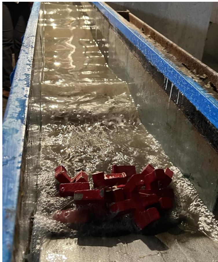
ფოტო VIII.3.9. „მოდირებული ტეტრაბლოკების“ ფერდზე ნაყარის ტალღაჩამქრობი ეფექტურობის კვლევა ჰიდრაულიკურ მცირე ღარში (10,0x0,3x0,70მ)
