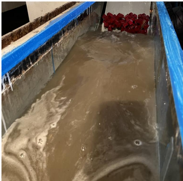
ფოტო VIII.3.7. „მოდფიცირებული ჰექსაბლოკებით“ ფერდზე ნაყარის ტალღაჩამქრობი ეფექტურობის კვლევა ჰიდრაულიკურ მცირე ღარში (10,0x0,3x0,70 მ)
