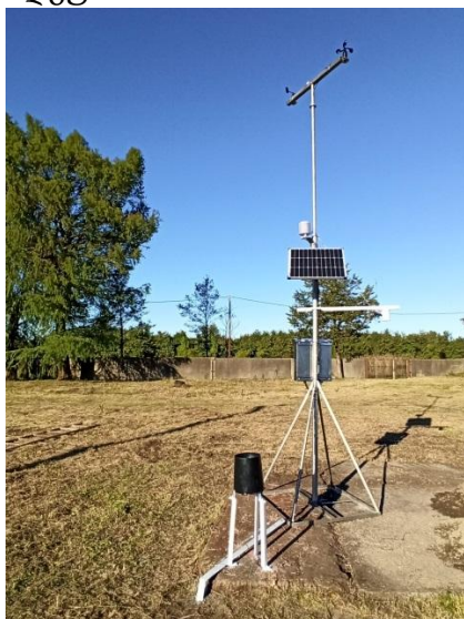
ფოტო 67-68. ინსტიტუტის ფოთის საცდელ-სამელიორაციო ეკოლოგიურ პუნქტში მინი მეტეოსადგურის დამონტაჟებისას
