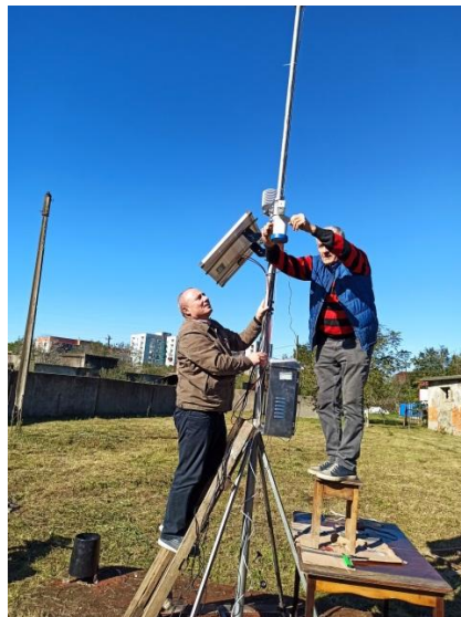
ფოტო 67-68. ინსტიტუტის ფოთის საცდელ-სამელიორაციო ეკოლოგიურ პუნქტში მინი მეტეოსადგურის დამონტაჟებისას
