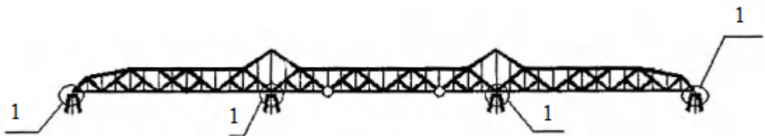
ფიგ. 18 უჭრ-კოჭური სისტემის, წამწეებიანი ლითონის ხიდის მწყობრიდან გამოყვანის სქემა: 1-საყრდენ ნაწილებში დაზიანება.
