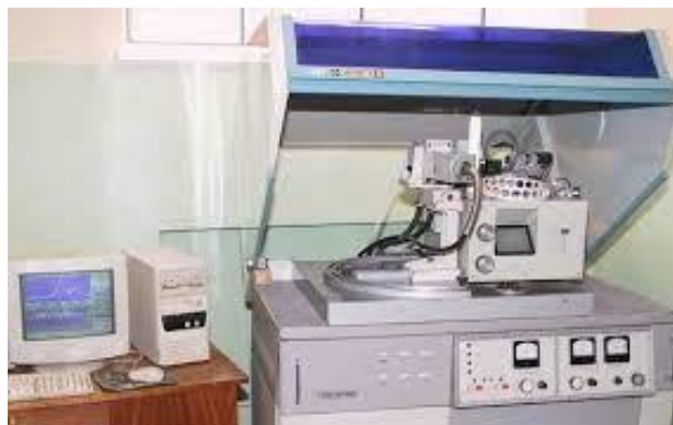
სურათი 8. რენტგენოდიფრაქტომეტრი ДРОН-3М
