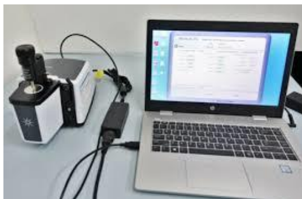
სურათი 7. ფირმა „Agilent Technologies“ იწ-სპექტრომეტრი „Cary 630 FTIR“
