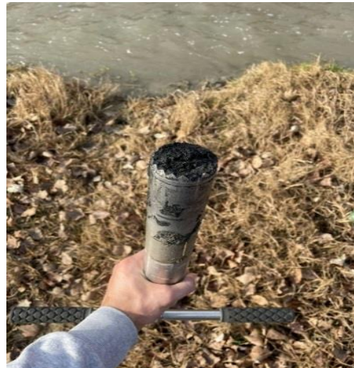
სურათი 5. ნიადაგის გრუნტის სინჯის ასაღები ლაბორატორიული ხელსაწყო - „ხელის ბურდი“
