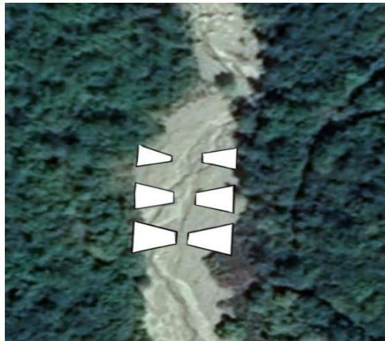
სურათი 13. მდ. ალისხევის კალაპოტზე ღვარცოფ-საწინააღმდეგო ნაგებობის განთავსების სქემა
