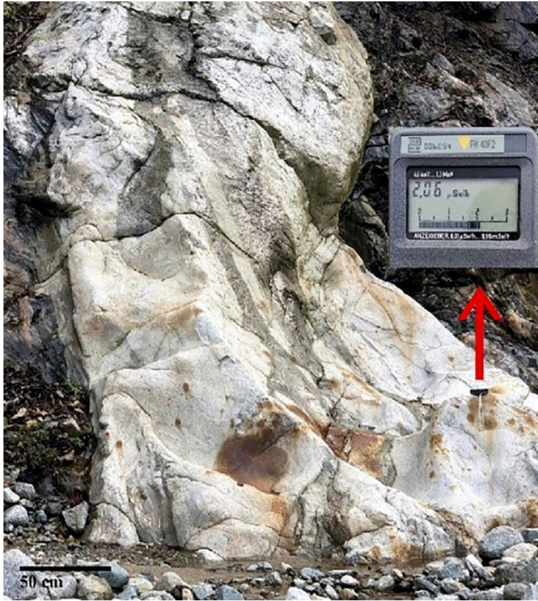
ნახ. 6.3. შხარის პლაგიოგრანიტული მარდვის საერთო ხედი და რადიაციული დოზა რადიოდოზიმეტრ FAG-FH40F2-ზე, რომელიც ამ წერტილში 2.06 \mu\text{Sv/h} შეადგენს.
