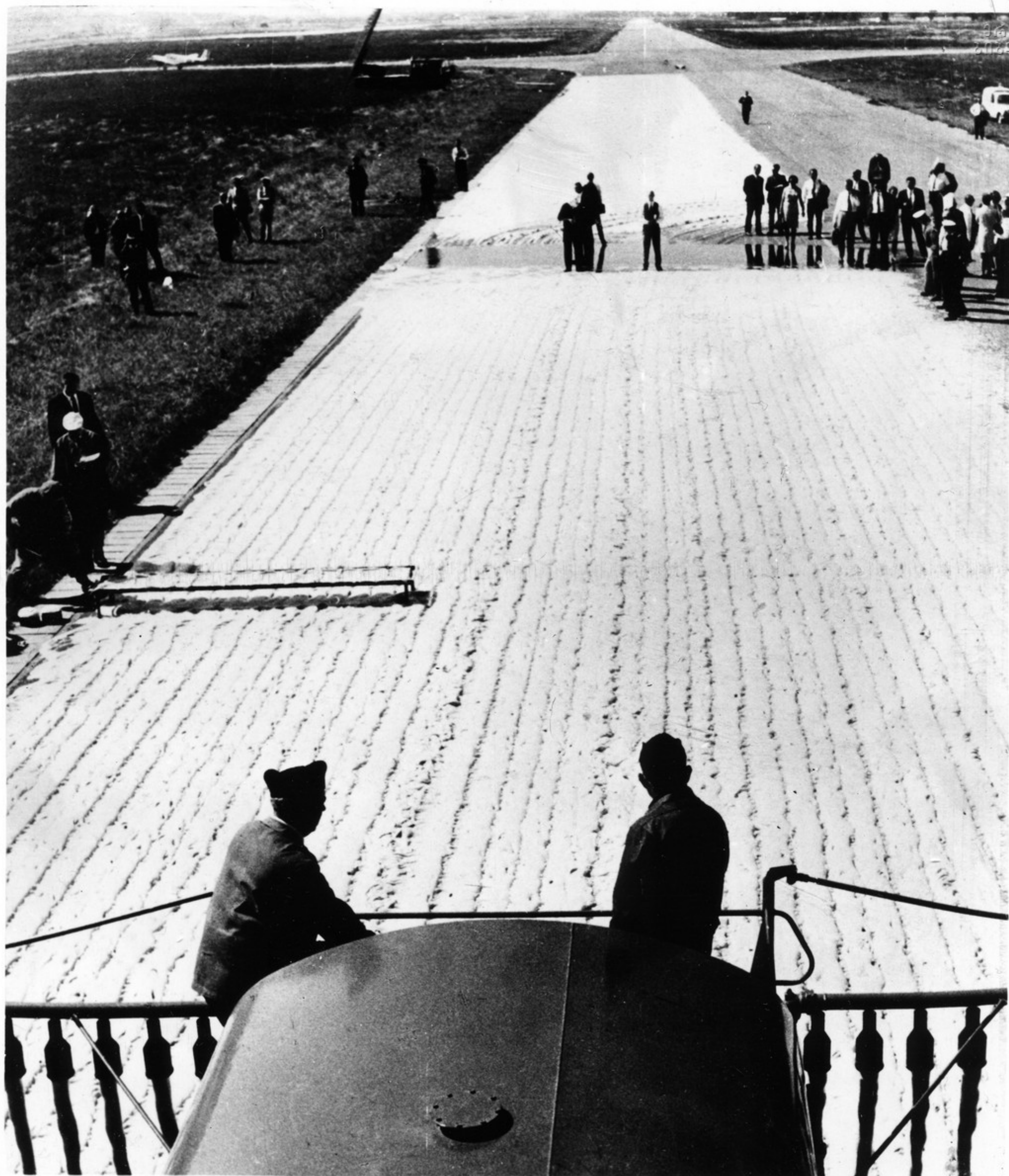
Франция. На аэродроме в Тулузе проводились испытания специального „ковра“ из пены, предназначенного для посадки самолетов в аварийном состоянии, в частности, с неисправными шасси. Такой „ковер“ может быть нанесен на посадочную полосу за считанные минуты.
