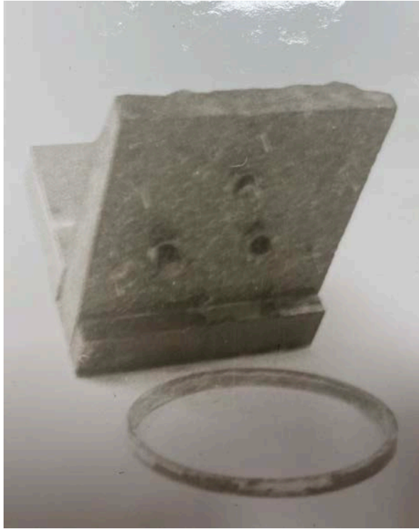
სურ. 13 გრანიტის ფილა ხისტად ჩამაგრებული ცილინდრებით
