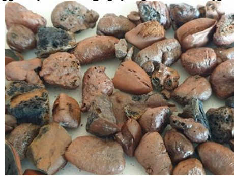
სურათი 11. კერამზიტი მიღებული ყვარლის თიხაფიქლისგან (10-20 მმ)
