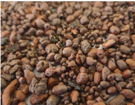
სურათი 9. კერამზიტი მიღებული ყვარლის თიხაფიქლისგან (5 მმ-მდე)
