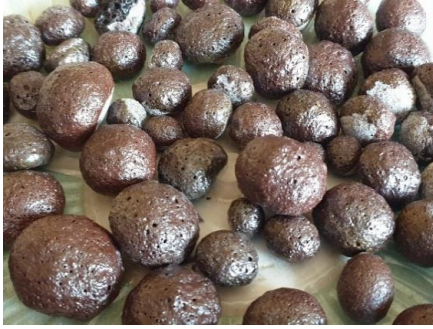
სურათი 7. კერამზიტი მიღებული გარდაბნის თიხისგან (10-20 მმ)
