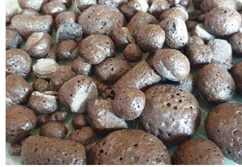
სურათი 8. კერამზიტი მიღებული თელეთის არგილიტისგან (5-20 მმ)
