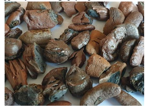
სურათი 12. კერამზიტი მიღებული ყვარლის თიხაფიქლისგან (20-40 მმ)
