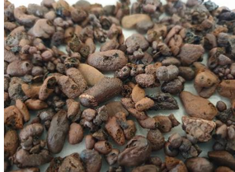
სურათი 10. კერამზიტი მიღებული ყვარლის თიხაფიქლისგან (5-10 მმ)
