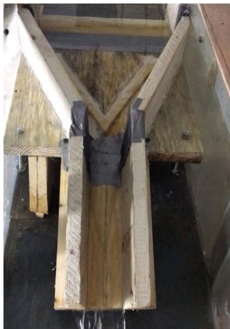
სურ. 9. არაპრიზმული არაცილინდრული მოდელის მეორე ვარიანტი სწრაფდენთან შემაუღლებელი ღარქიმიანი ნაგებობის მოდელის
