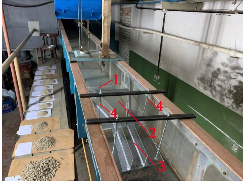
სურ. 6. ფართოზღურბლიანი წყალსაშვის წყალსაგდებ ნაგებობასთან შეუღლების ჰიდრავლიკური მოდელი
