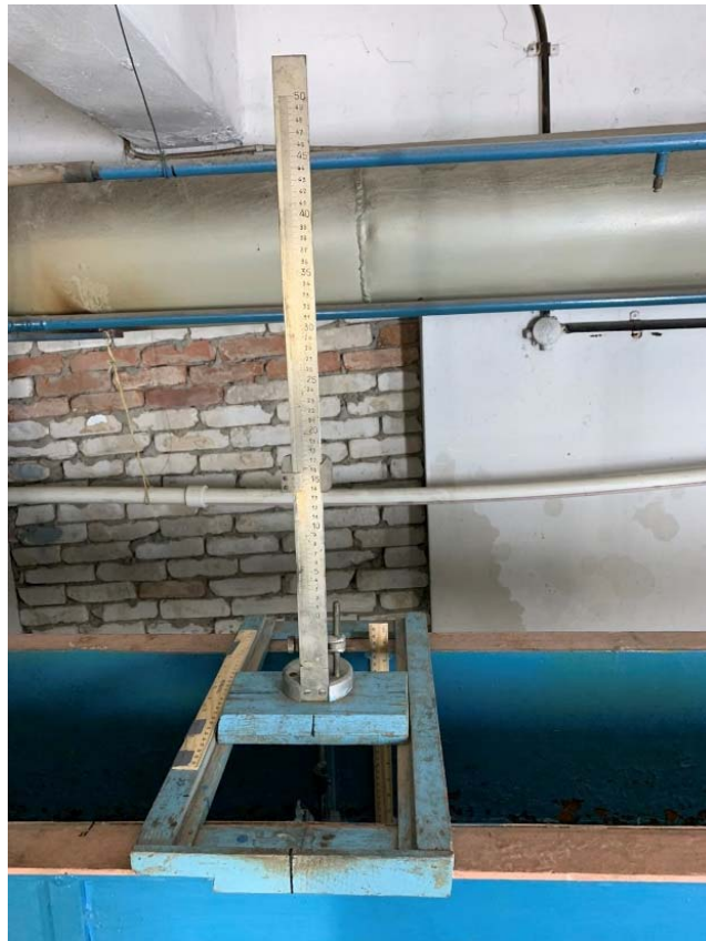
სურ. 3. წყალთამეურნეობის ინსტიტუტის ბაზაზე ჰიდროვლიკურ ლაბორატორიაში არსებული ჰიდროვლიკური ღარის მზომი ხელსაწყო
