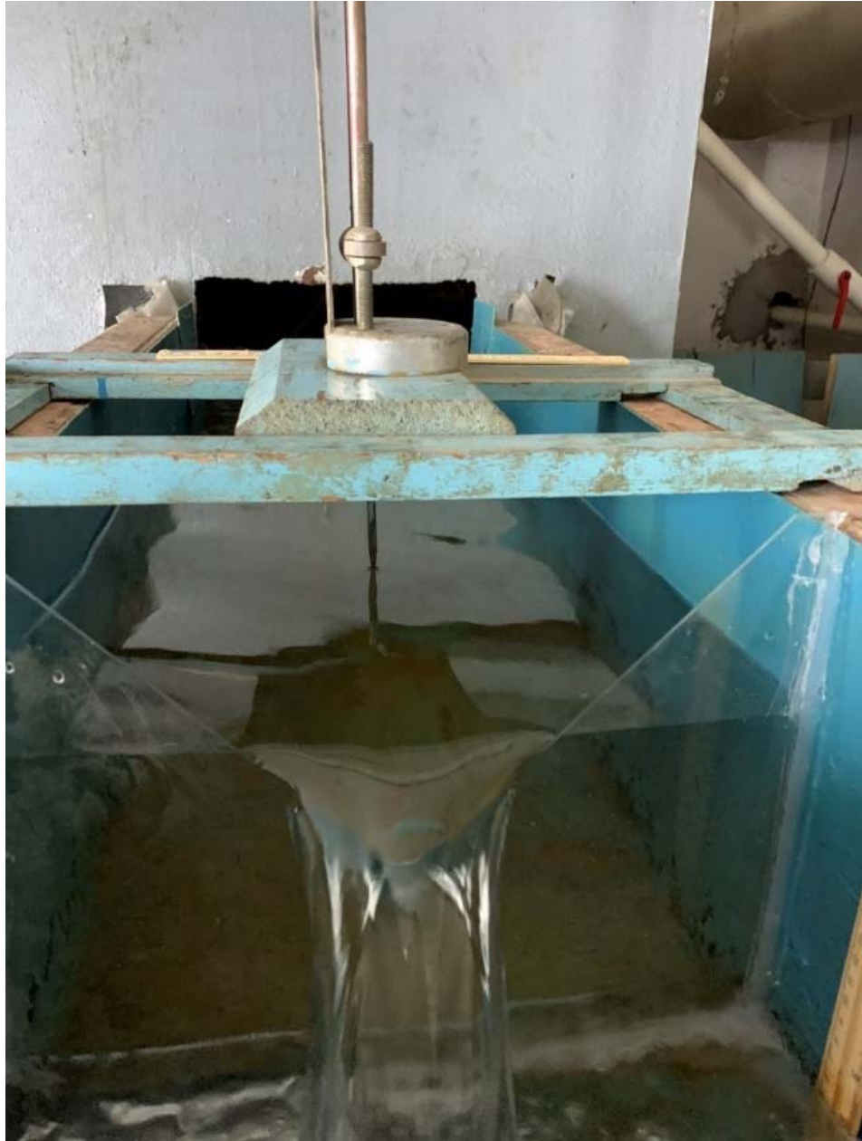
სურ. 5. წყალთა მეურნეობის ინსტიტუტის ბაზაზე არსებულ ჰიდრაულიკურ ღარში განთავსებული თხელკედლიანი სამკუთხა ტიპის წყალსაშვი.
