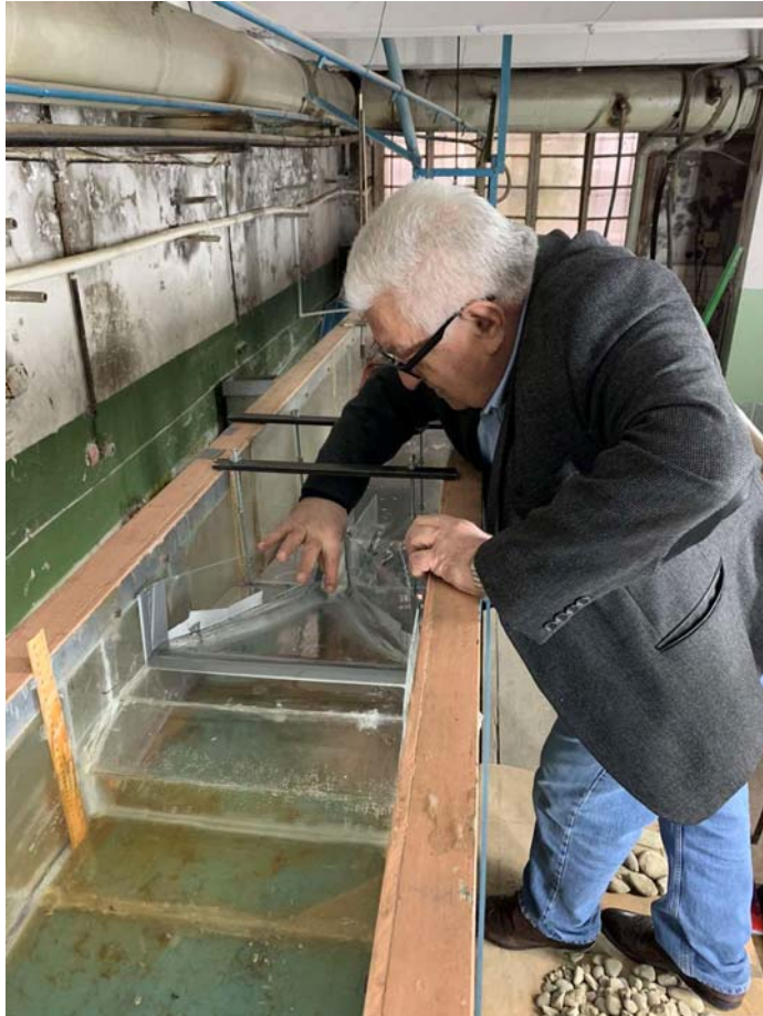
სურ. 8. არაპრიზმულ, არაცილინდრულ შემაუღლებელ ნაგებობაზე ნაკადის აზვირთების პროცესის დაკვირვება პროფესორ ი. ქადარიას მიერ ექსპერიმენტული ცდის მსვლელობის პროცესში.
