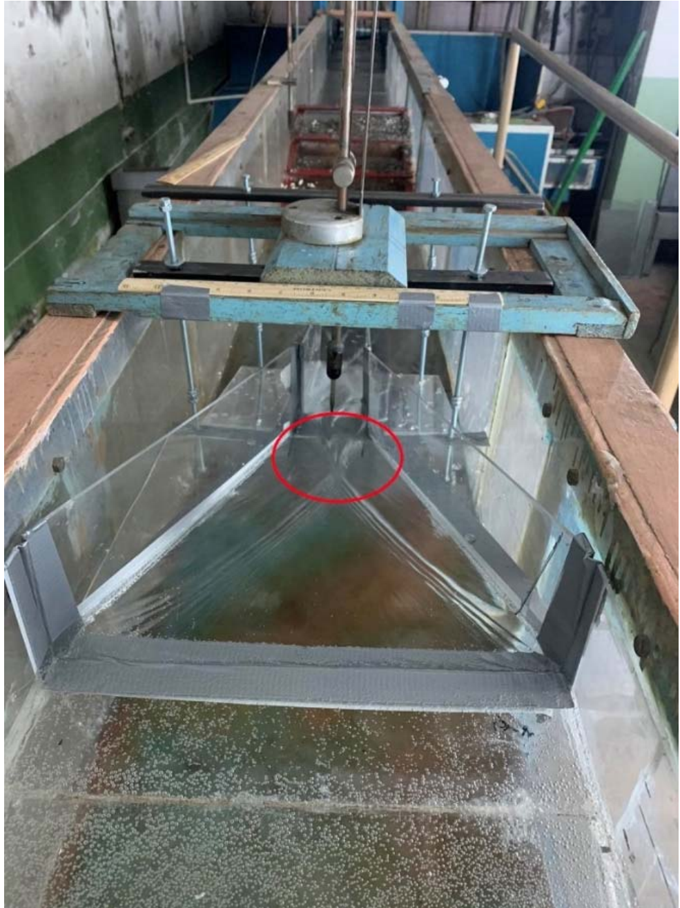
სურ. 7. არაპრიზმულ, არაცილინდრულ შემაუღლებელ ნაგებობაზე ნაკადის აზვირთება.
