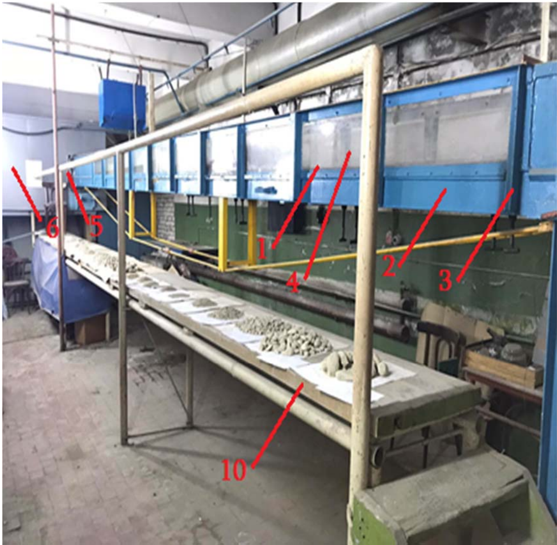
სურ. 1. წყალთამეურნეობის ინსტიტუტის ბაზაზე ჰიდრაგლიკურ ლაბორატორიაში არსებული ჰიდრაგლიკური ღარი
