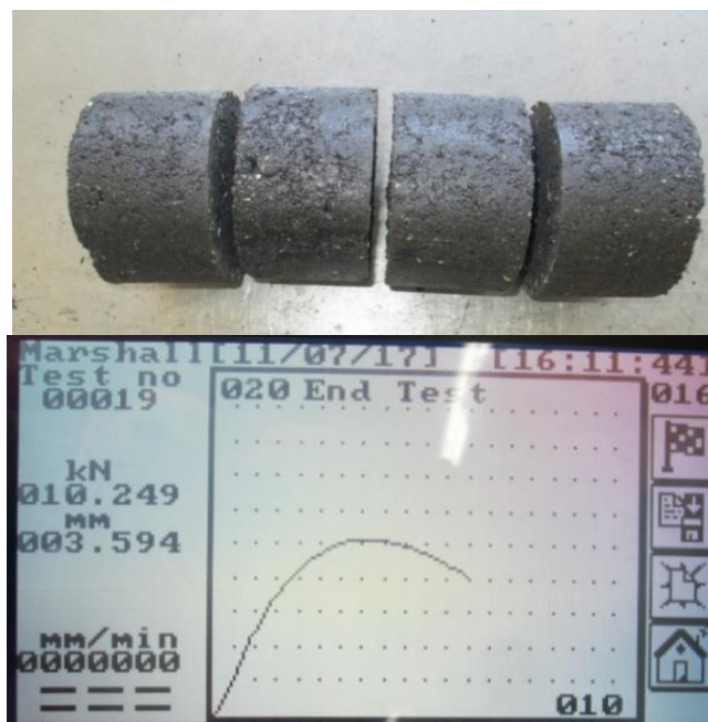
ნახ. 14. 10% მოდიფიცირებული გოგირდით დამზადებული გოგირდასფალტბეტონის მარშალის ნიმუშების გამოცდა სტაბილურობასა და დენადობაზე
