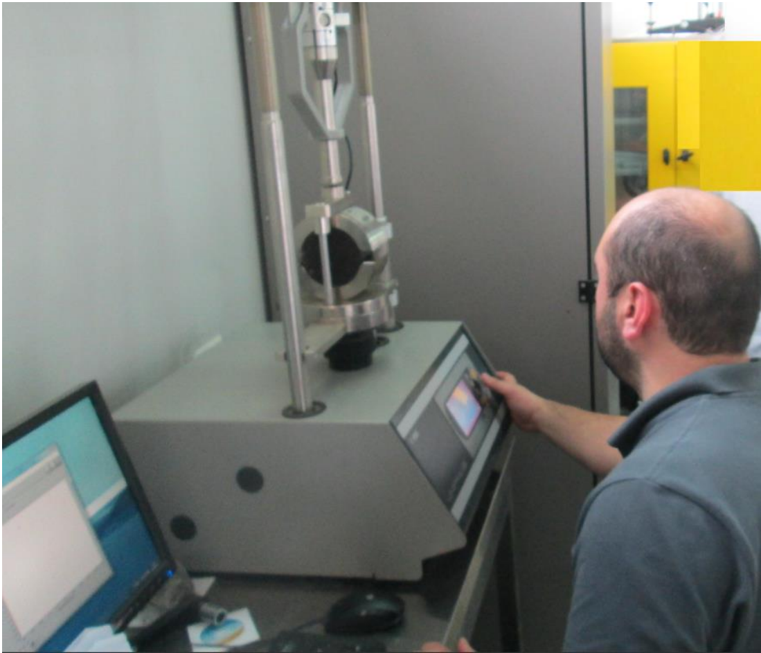
ნახ. 12. უდანამატო ასფალტბეტონის მოდიფიცირებული გოგირდის 10%, 20%, 30% დანამატით დამზადებული გოგირდასფალტბეტონის მარშალის ნიმუშების გამოცდის პროცესი მარშალის ტესტის ხელსაწყოზე
