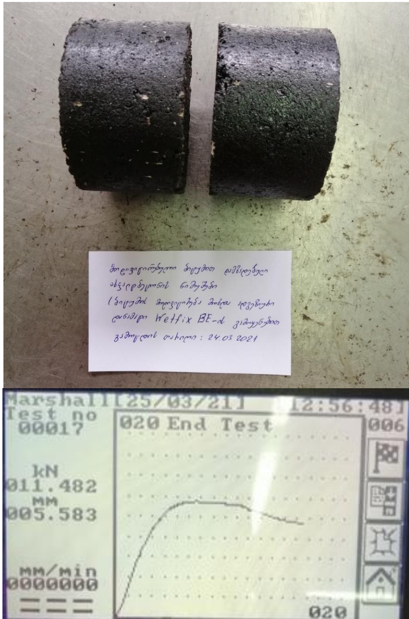
ნახ. 17. ადგეზიური დანამატის „Wetfix Be“-ის გამოყენებით დამზადებული მარშალის ნიმუშების გამოცდა სტაბილურობასა და დენადობაზე
