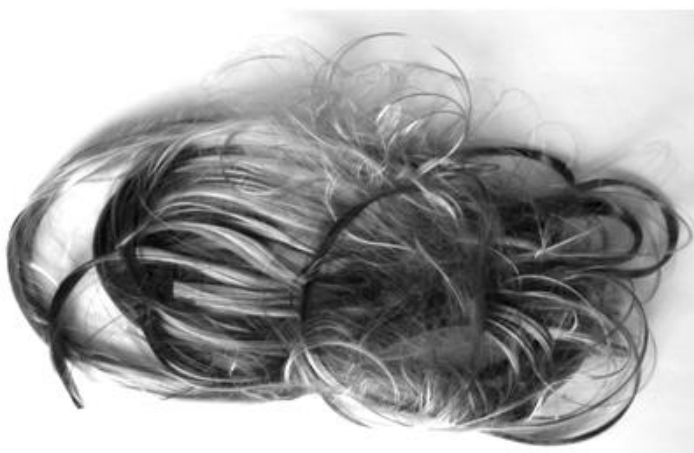
ნახ. 4. მანგანუმშემცველი ნარჩენებისგან მიღებული უწყვეტი მინის ბოჭკო
