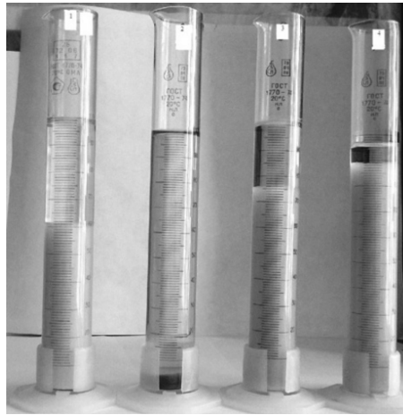
Рис.1. Набухающая способность бентонитов: 1 – греческий бентонит (через 3 суток); 2 – асканглина (через сутки); 3 – аскангель (через сутки); 4 – Мтиспири 1 (через 30 суток).
