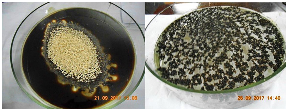
სურათი4. ფიჭვის ხის ნახერხის გამოყენებით ნავთობის ფენის ლოალიზება წყლის ზედაპირზე
