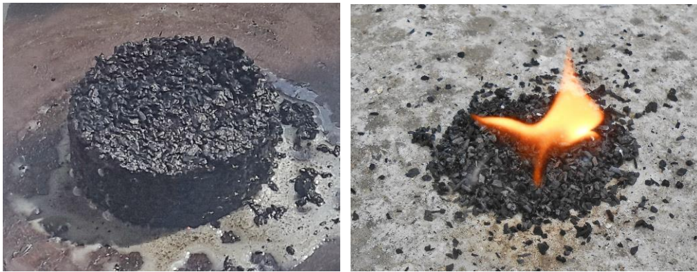
სურათი 5. დაბრიკეტებული ნავთობ-ნახშირის კონგლომერატი და მისი წვის პროცესი
