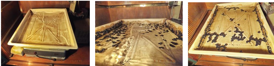
სურათი 3. ნავთობის შეწოვა ნახშირის მიერ მექანიკურ სანჯღრეველაზე
