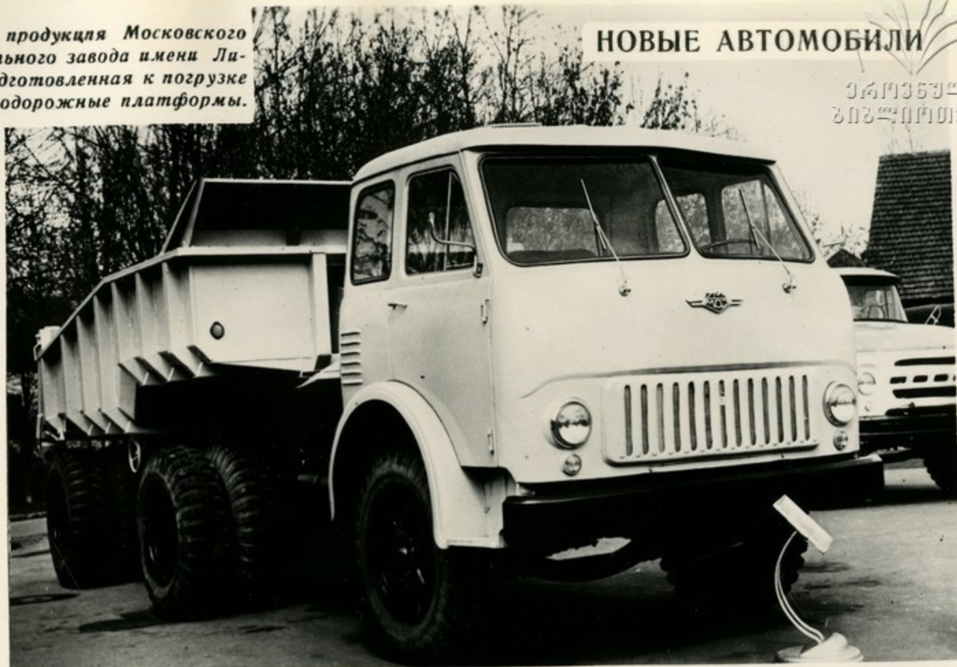
Седельный тягач Минского автомобильного завода «МАЗ-504Б» с полуприцепом-самосвалом грузоподъемностью 13,5 тонн.
