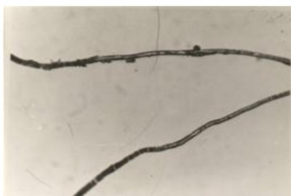
Рис.2. Фотоснимки концов бескруточной пряжи после испытания на разрывной машине
