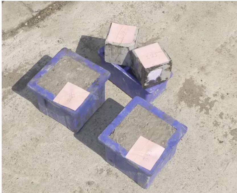
ფოტო 3.1. ექსპერიმენტისათვის მომზადებული ბეტონის კუბების ნიმუშები.
