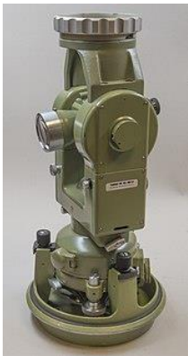
ნახ. ოპტიკური თოდოლიტი; 1 – ობიექტივი; 2 – ოპტიკური ვიზირი; 3 – თარაზო; 4 – ვერტიკალური წრის მიმყვანი ხრახნი; 5 – ჰორიზონტალური წრის მიმყვანი ხრახნი; 6 – ტრიგერის ამწყვი ხრახნი.
