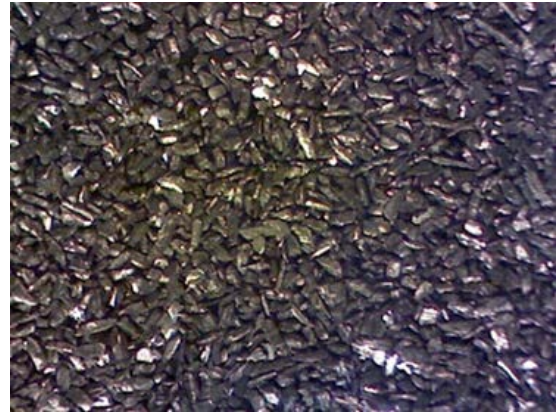
სურ.2. სხმულების დისპერგირებით მიღებული ფხვნილი ზომებით 1,5–0,4 მმ X9 (ა) და 0,02–0,016მმ X9 (ბ)
