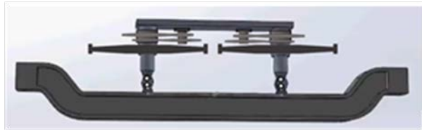
ნახ.4. ავტომობილის რეკუპერაციული საკიდრის ფრონტალური ხედი დამაჩქარებელი გადაცემით
