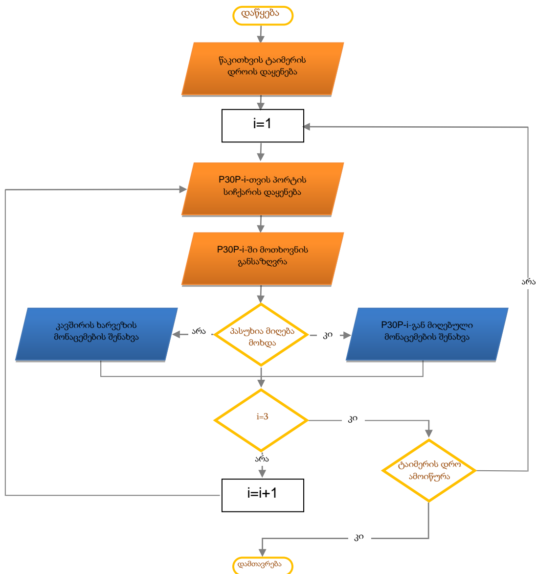
ნახ. 2. RTU მოწყობილობებთან MTU მოწყობილობის ინტერაქციის ალგორითმი
