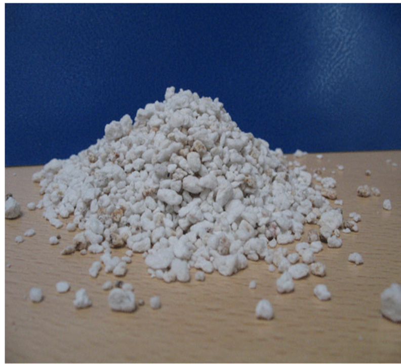
სურ. 3. პერლიტი, როგორც ბეტონის დამზადებისათვის შემავსებელი
